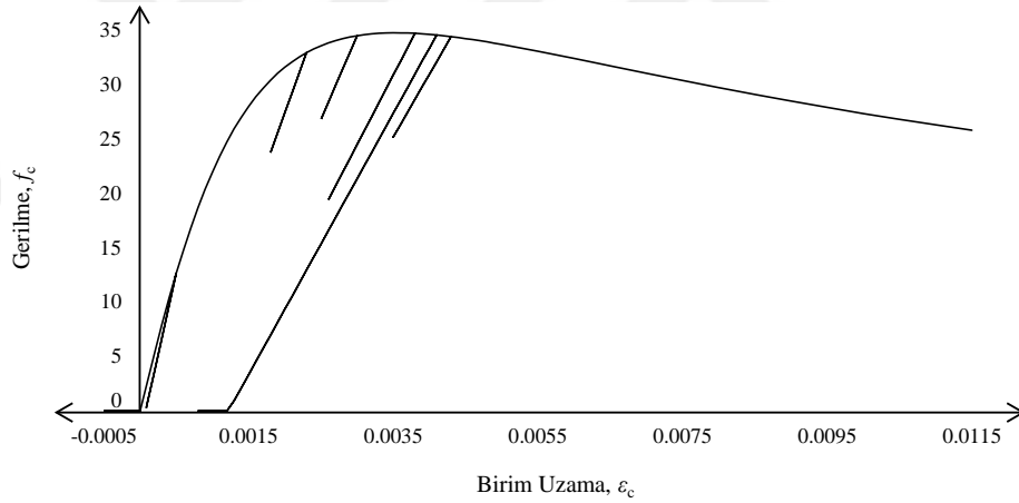
Şekil 3.5 : Sargılı kesit için çevrimsel davranış ilişkisi.
