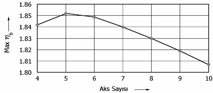
Şekil 2.6 : 10 Katlı farklı aks sayısına sahip binalarda burulma düzensizliğinin değişimi (Özmen, 2004).
