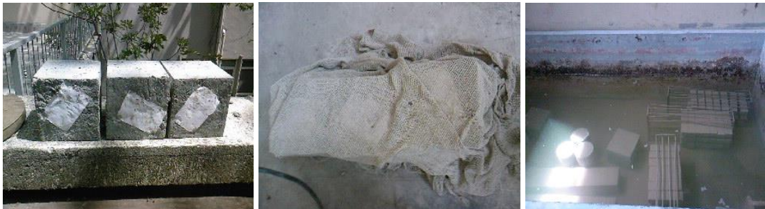
Şekil 11.3 : Üretilen numunelerin kür ortamları.
