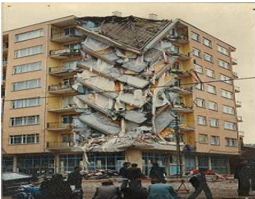
Şekil 4.3 :Köşe kolon göçmesi sonrasında hasar alan binalar (Kaplan ve diğ, 2015).
