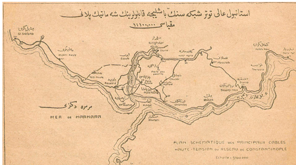
Map.2.1 The Layout of the Main Cables of Istanbul’s High-Voltage Electric Network, Scale: 1/ 100,000 (İstanbul Âli Tevettür Şebekesinin Kablolarının Şematik Planı Mikyası 1/ 100,000)
