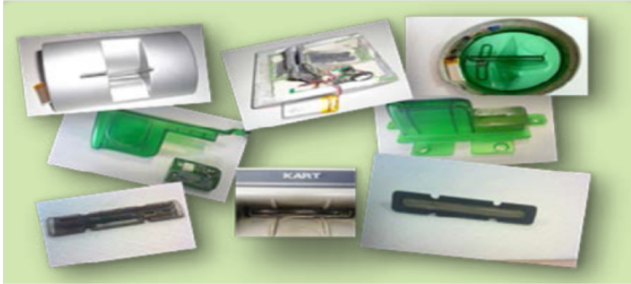
ŞEKİL 1.1: Kopyalama İşleminde Kullanılan (Skimmer) Kopyalama Cihazı Örnekleri
