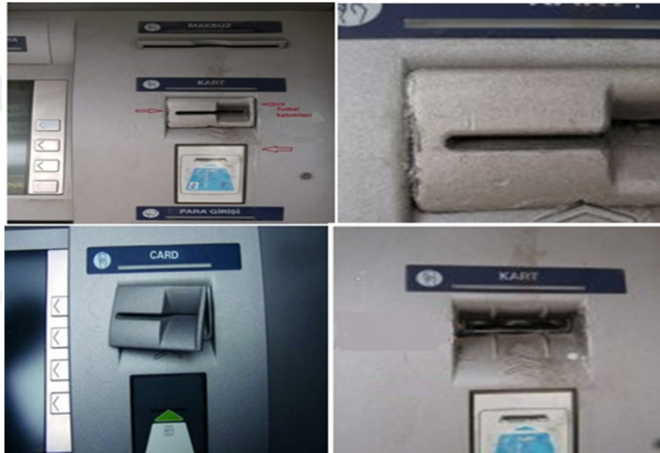
ŞEKİL 1.3: Kart Kopyalama Düzeneginin ATM' ye Yerleşimi
