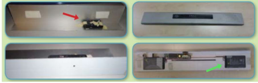
ŞEKİL 1.2: Kopyalama İşleminde ATM' ye Takılan Kamera Düzenegi
