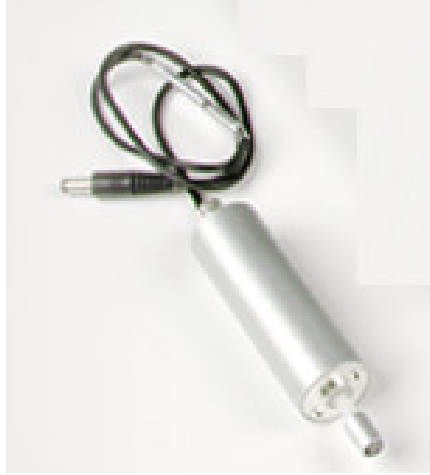
ŞEKİL 6.1: Yüksek hassasiyetli EM alan alıcısı
