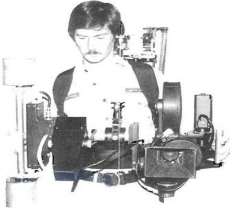
Şekil 58:Maine Shinko Workshop’undan Steadicam Mekanizması Kaynak: Brown, G, (1989), “The Contraption Wars”, Steadicam Letter, USA, 3.
