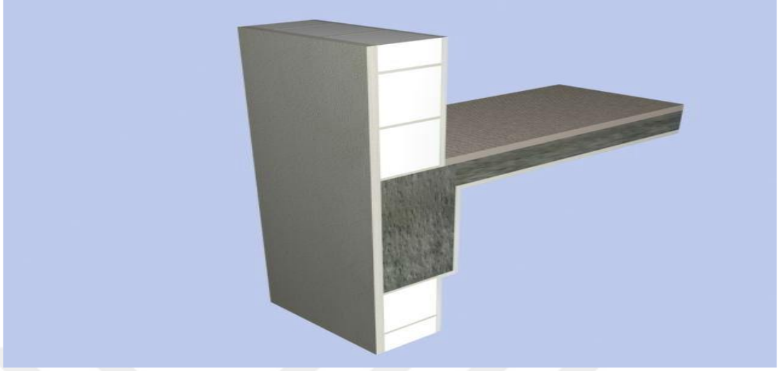
Şekil 11.1.7. Isı yalıtımsız duvar (Aygün ve Kuş 1994)
