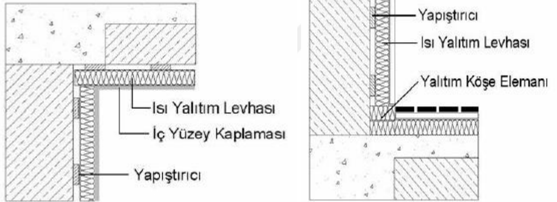
Şekil 11.1.16.Duvar – tavan birleşim detayı Şekil11.1.17Duvar – döşeme birleşim detayı
