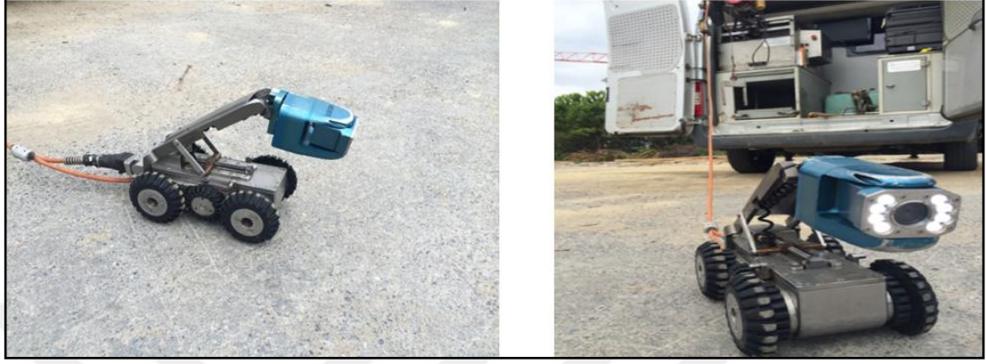
Şekil 1 Kameralı robot (CCTV)
