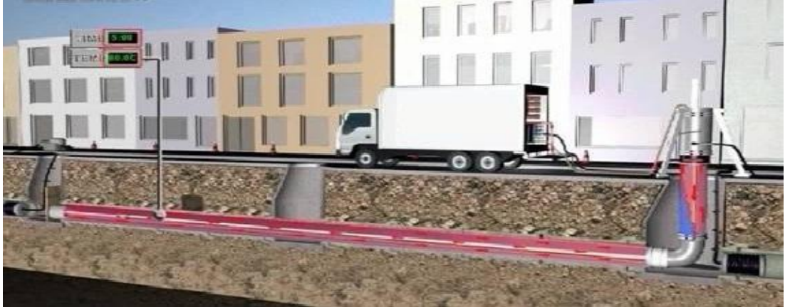
Şekil 22 CIPP Yöntemi İle Kaplama İşlemi Şematik Görünümü
