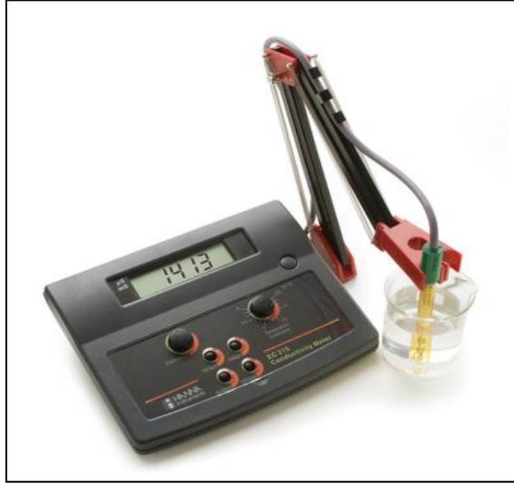
Şekil 3.11. Hanna Instruments EC 215
