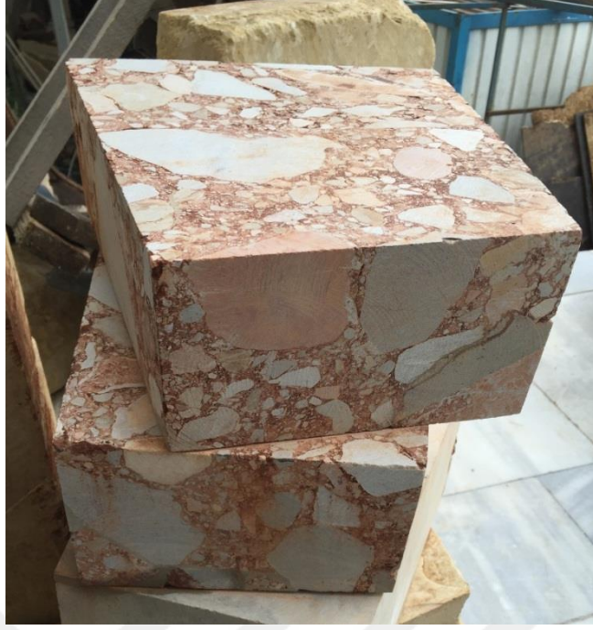
Şekil 6.13: İzmit, Hereke bölgesinden temin edilen Hereke pudingi taş (2018)
