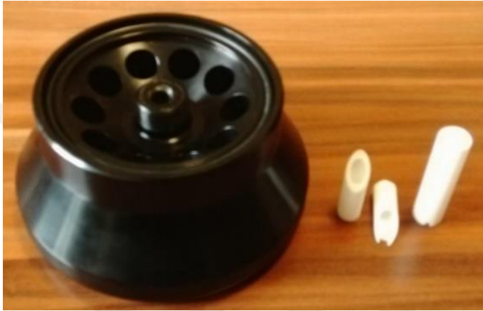
Şekil 3.5. 3 boyutlu yazıcı ile üretilmiş örnek tutucu tüpler (solda 50 mL hacimdeki tüpler ve sağda 5 mL hacimdeki tüpler)
