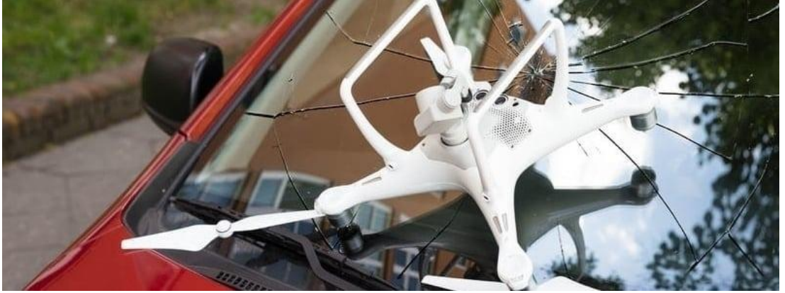
Şekil 2-1 İHA kazası sonucu oluşan bir hasar [54]
