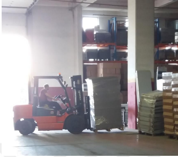
Resim 4.4 Hatalı yükleme yapmış forklift(M. Akcan Çelik, 2019)
