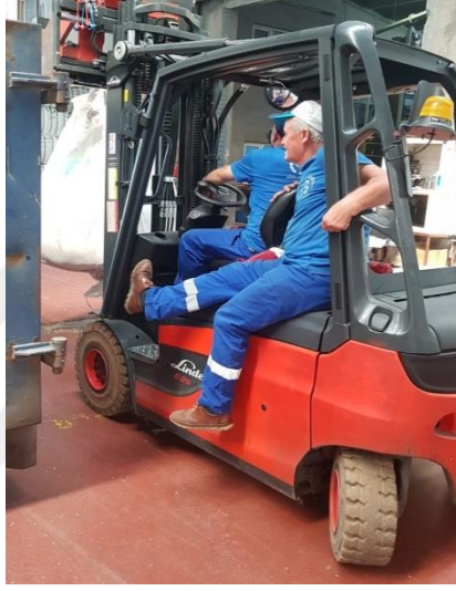
Resim 4.13 Forkliftlerde operatör ve yük dışında insan taşıma(M.Akcan Çelik, 2019)
