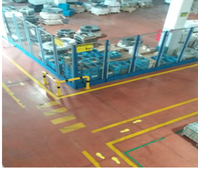
Resim 4.15 Forklift-yaya yolları belirlenmiş çalışma ortamı(M.Akcan Çelik, 2019)
