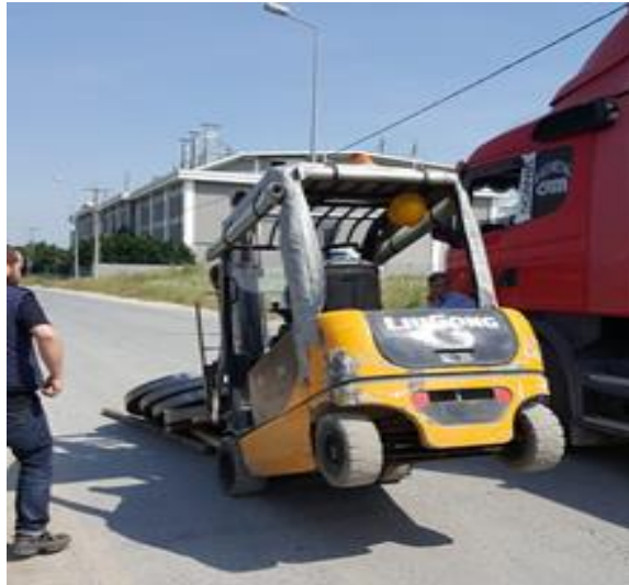
Resim4.7 Sahada kapasitesinden fazla yükleme yapılan forklift(M.Akcan Çelik, 2019)
