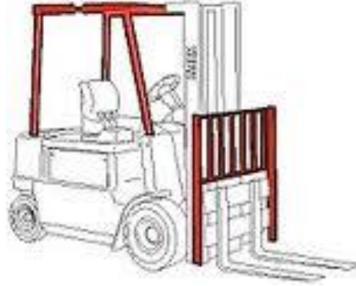
Şekil 3.3 Forklift koruma ataşmanları ( Forklift Ehliyeti )
