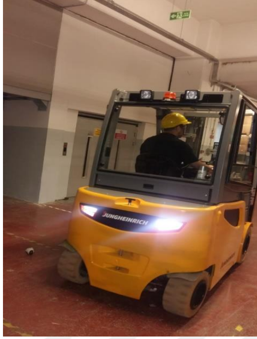
Resim3.12 Forklift uyarı sistemleri(M.Akcan Çelik, 2019)
