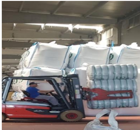
Resim 4.21 Uygun olmayan istifleme(M.Akcan Çelik, 2019)
