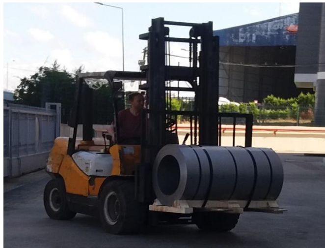
Resim 4.5 Doğru ve dengeli taşıma yöntemi(M.Akcan Çelik, 2019)
