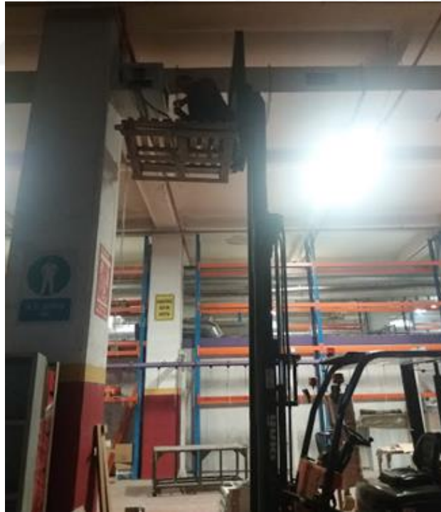
Resim 4.31 İnsan taşıma sepeti olmayan çalışma(M.Akcan Çelik, 2019)
