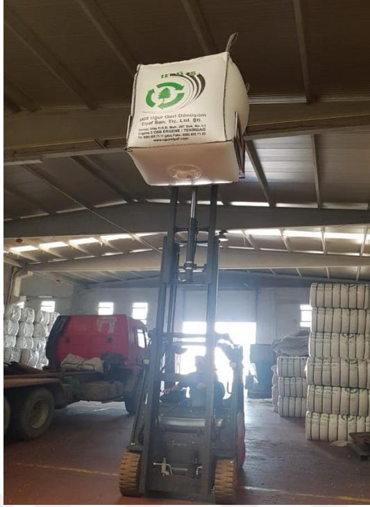
Resim4.6 Hatalı taşıma yöntemi (M.Akcan Çelik, 2019)
