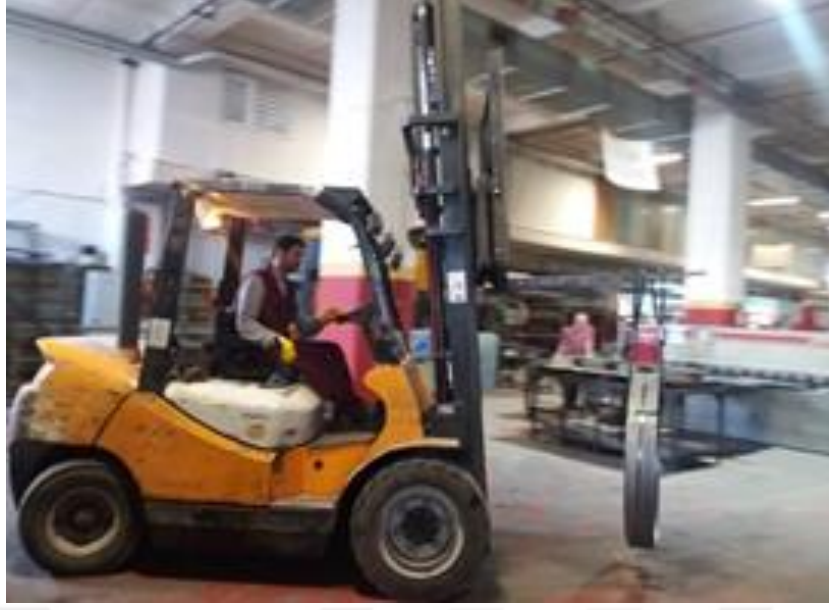
Resim4.10 Forkliftte sapanla yük taşıma(M.Akcan Çelik, 2019)
