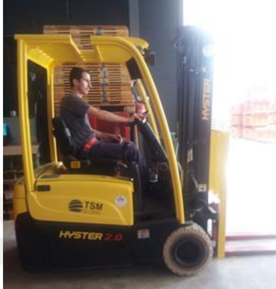
Resim 3.11 Sahada forklift kullanırken kemer takmış operatör(M.Akcan Çelik, 2019)
