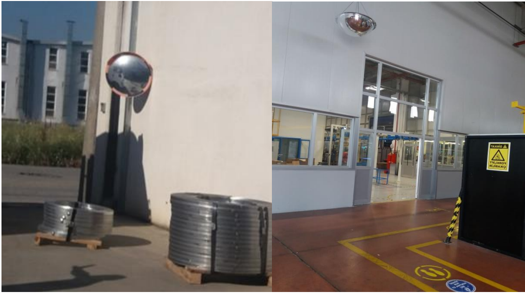
Resim 4.20 Forkliftler için tümsek aynanın önemi(M.Akcan Çelik, 2019)
