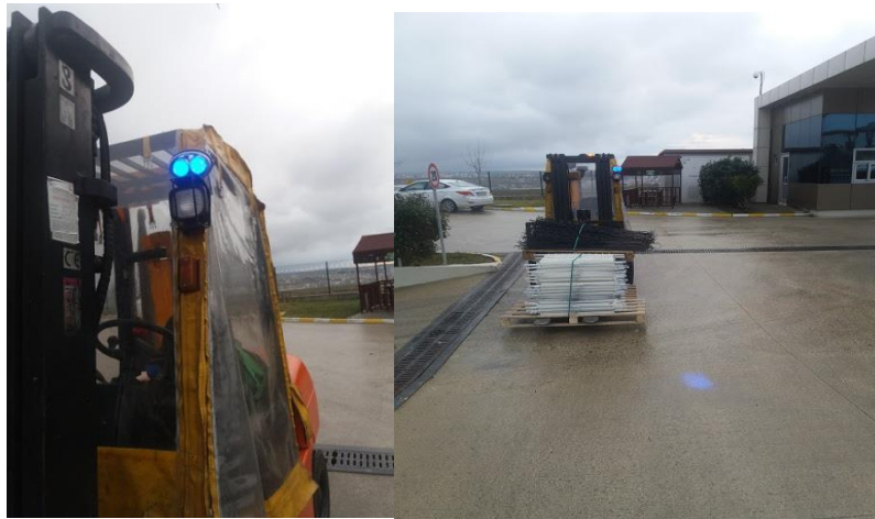
Resim 4.18 Mavi ışık yaklaşma mesafesi belirleme(M.Akcan Çelik, 2019)
