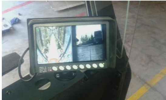
3.15 Forklift geri görüş kamerası(M.Akcan Çelik, 2019)
