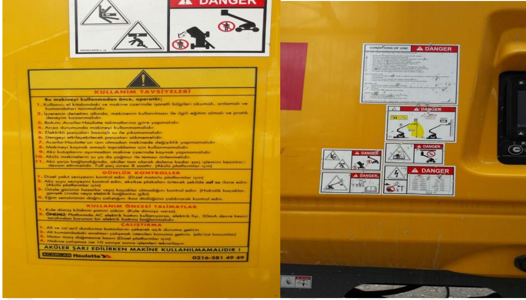
Şekil 5.9. Yüksekte çalışmada kullanılan Man lift kullanma talimatı. (Etibakır İşletme sahası, 2019)
