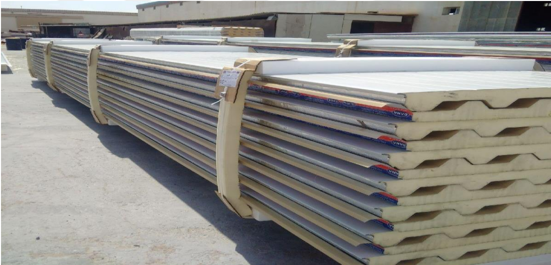
Şekil 5.5. Sandviç panellerin paketlenmesi (etibakır işletme sahası,2019)
