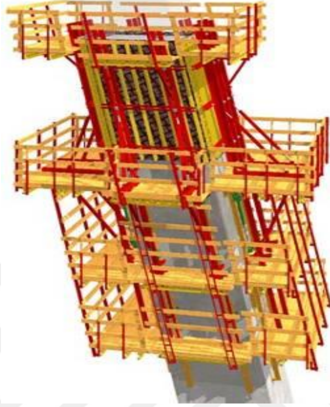
Şekil 27: ACS Kendinden Tırmanır Kalıp Sistemleri ve Koruma Önlemleri
