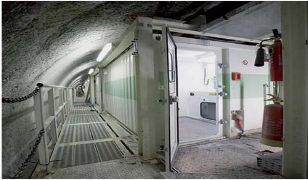
Şekil 14. Bir yaşam odasının maden içinde yerleştirilmiş şekli ( https://www.draeger.com/Products/Content/eto-refuge-chambers-pi-9101196-tr-tr.pdf Erişim Tarihi:21/01/2020)
