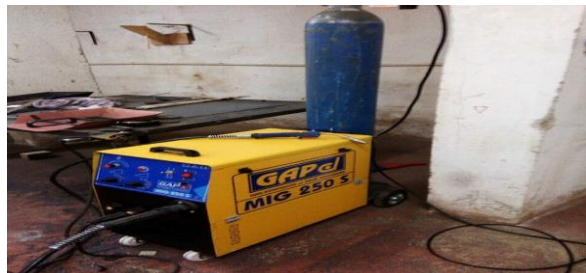
Resim-2.16. Gaz Altı Kaynağı.
