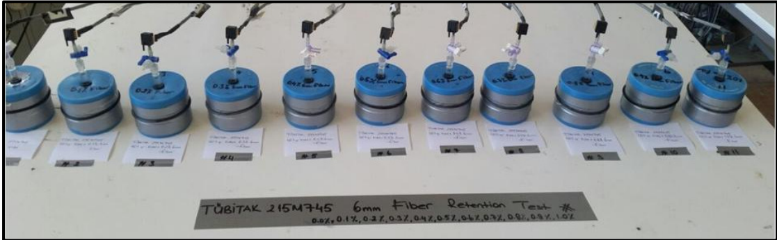
Şekil 4.3. Su tutma testi için 11 adet numunenin (1 adet katkısız + 10 adet 6 mm lif katkılı) hazırlanması ve boşluk suyu basınçlarının tansiyometreler tarafından ölçümü
