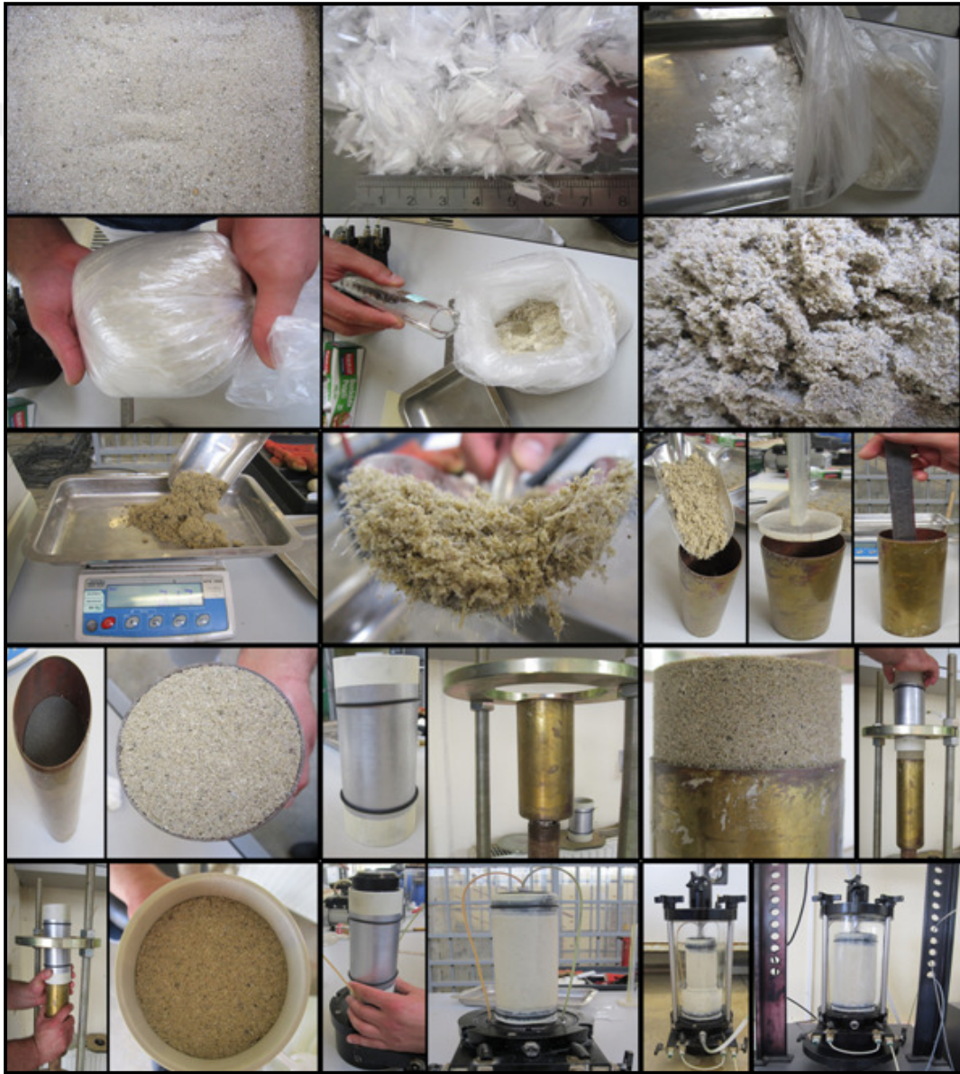
Şekil 4.2. Üç eksenli basınç testleri (CD) için lif katkıli numune hazırlanışı
