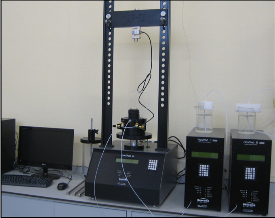
Şekil 3.1. Üç eksenli basınç testi çerçevesi, boşluk suyu ve hücre basıncı pompaları
