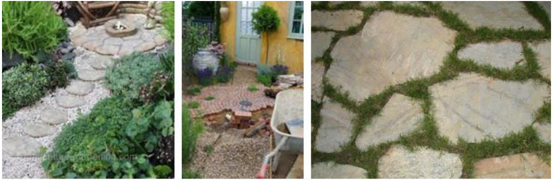
Şekil 4.22. Geçirgenlik özellikli taş döşemesi
