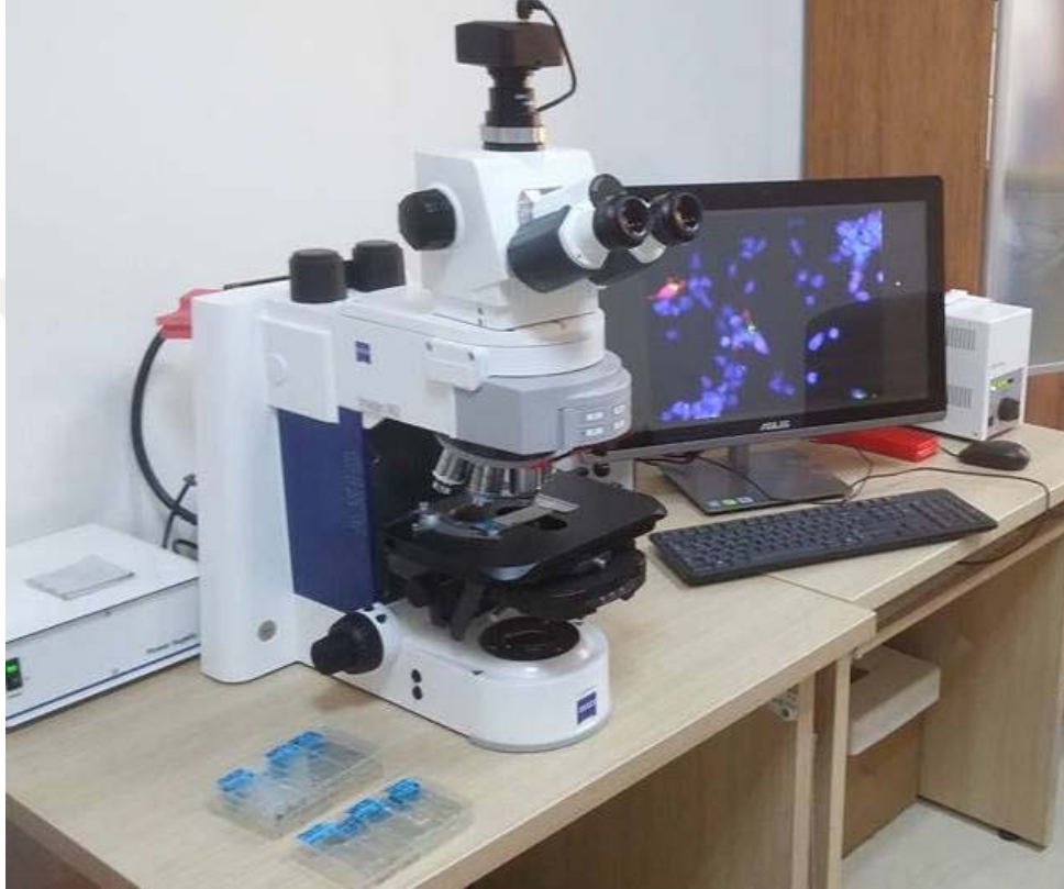
Şekil 17. Renkli hücrelerin sayımının yapıldığı floresan mikroskop.
