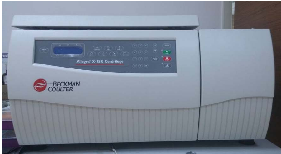
Şekil 11. HEK-293 hücre hatlarının santrifüj edildiği cihaz (Allegra X-15R Centrifuge, BECKMAN COULTER).
