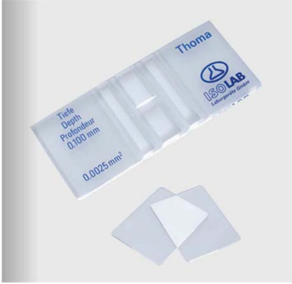
Şekil 13. Hücre sayımı için kullandığımız thoma lamı ve sayımın yapıldığı ortadaki 25 küçük kare
