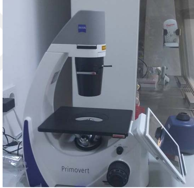
Şekil 14. Normal HEK-293 hücrelerinin sayımının ve görüntülenmesinin yapıldığı Primovert, Zeiss marka inverted mikroskobu
