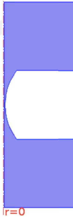
Şekil 16. Gövde kısmı içe doğru kavisli olarak idealize edilmiş tek-tip çift-konik nanogözenek geometrisi
