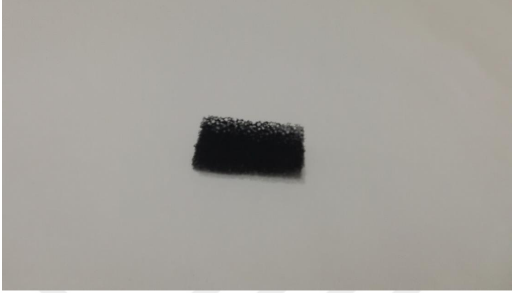
Şekil 39: Oluşturulan 3 nm poliüretan soğurucu sünger
