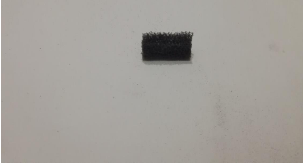
Şekil 44: 340 mg 6 nm' lik grafen soğurucu sünger
