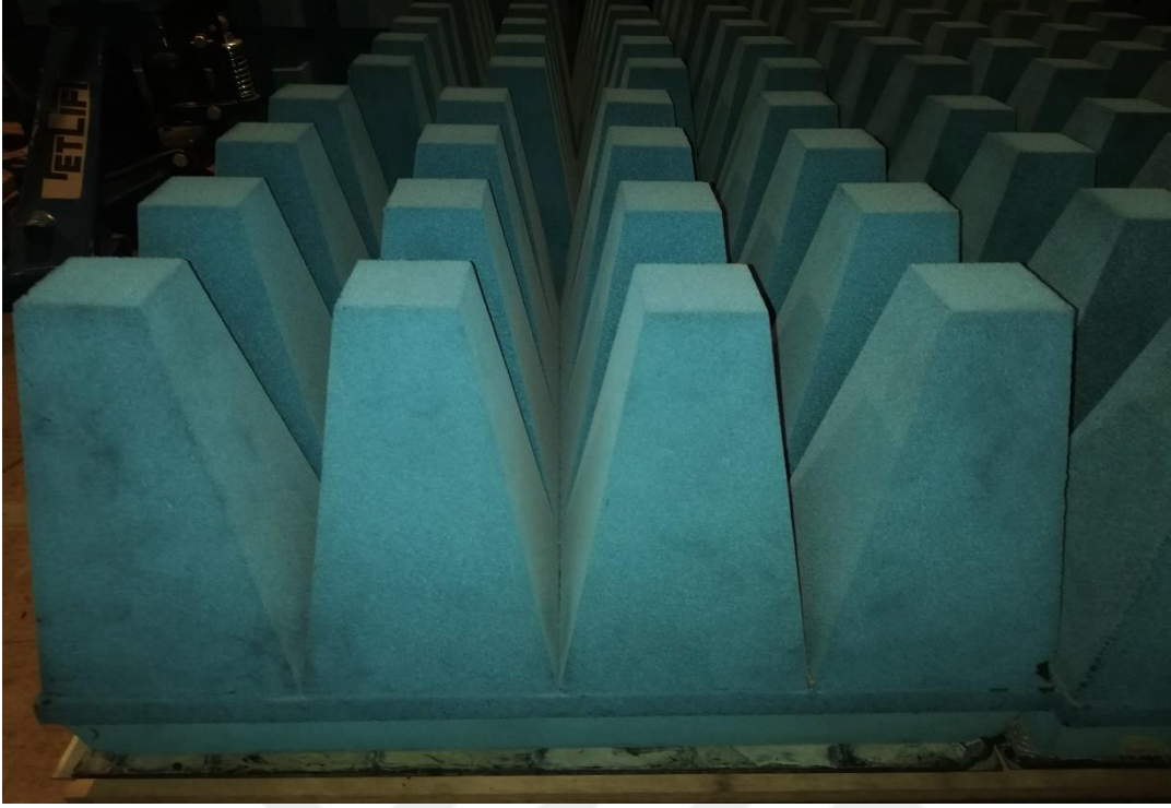
Şekil 15: Hibrid poliüretan soğurucu sünger.
