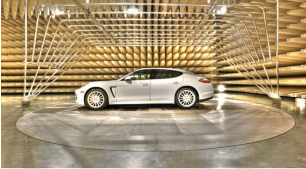
Şekil 8: Otomotiv testleri için kurulmuş yansımaz oda
