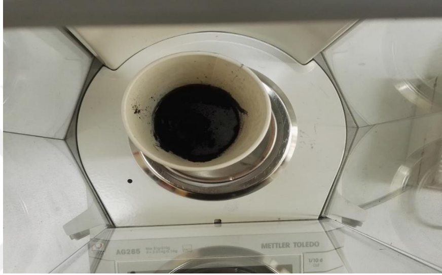
Şekil 30: Epoksi boya- grafen karışımı örneği
