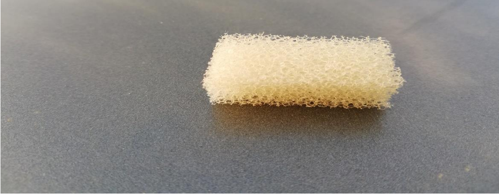
Şekil 24: 5-6mm kalınlığında kesilmiş poliüretan soğurucu sünger örneği
