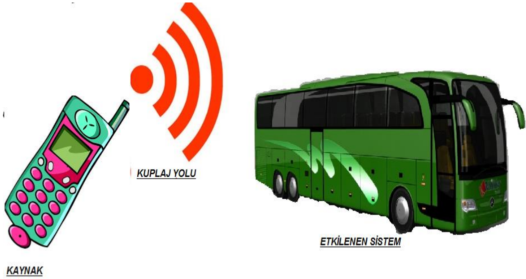
Şekil 4: Otobüslerin fren sistemlerinin cep telefonundan etkilenmesi.
