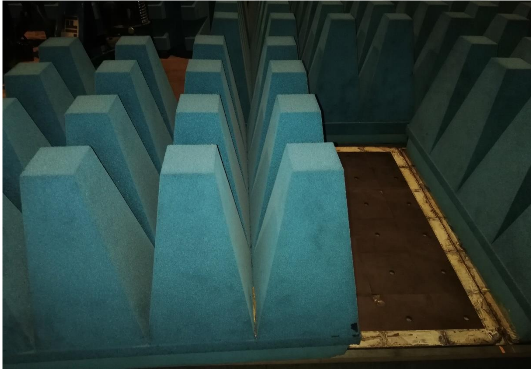
Şekil 16: Hibrid- Ferrit soğurucu.
