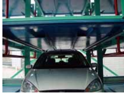
Şekil 3.77 Bina içi-Araba Rafları (Dolu Hali) [28,29]
