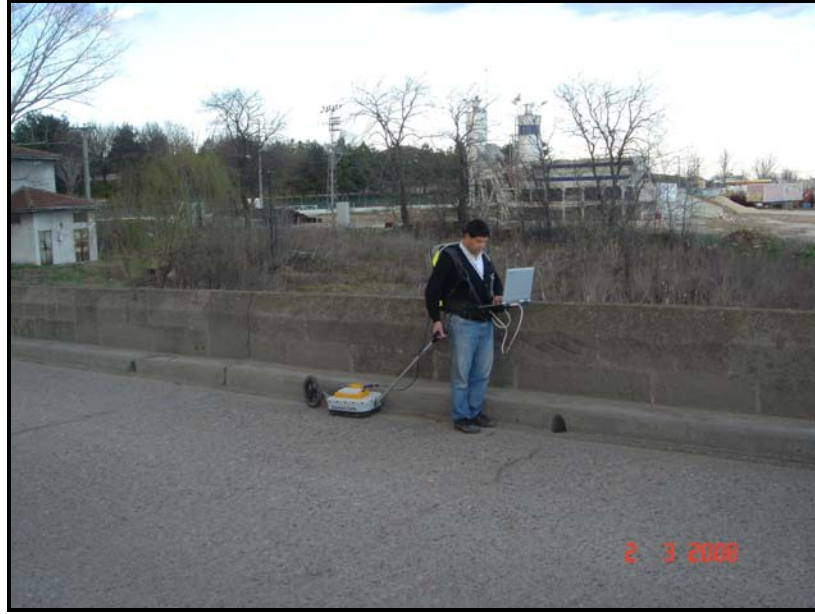
Foto 10. Köprü Üzeri Radar Ölçümü.
