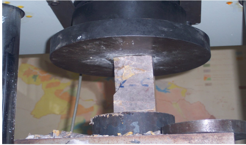
Foto 16- Deney Numunesinin Preste Kırılması
