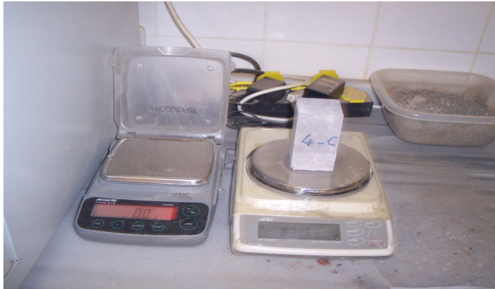
Foto 10- Numunenin Hassas Terazide Kuru Ağırlığının Tartımı
