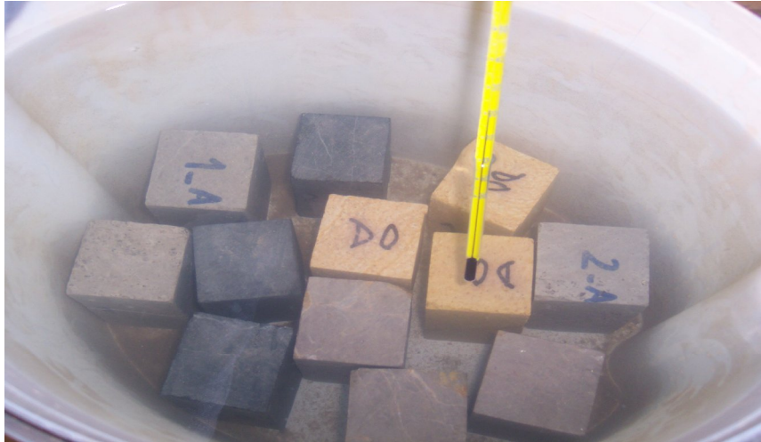
Foto 14- Numunelerin Çözülme Aşamasında Su İçerisinde 2 Saat Bekletilmesi
