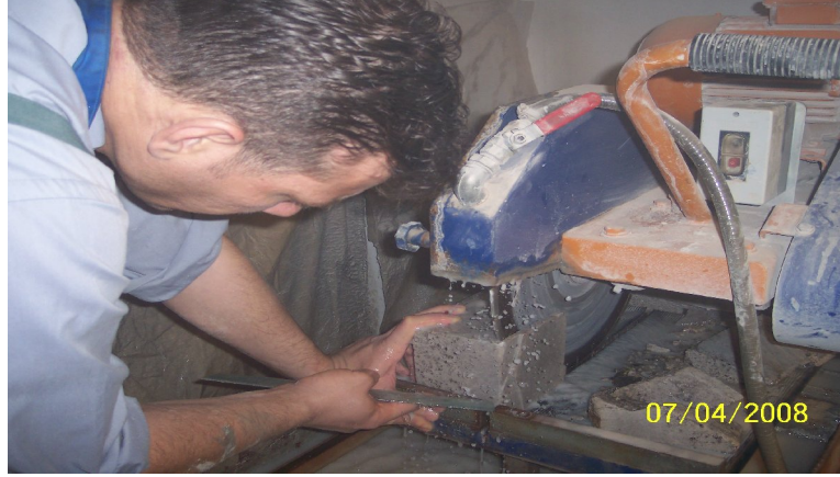
Foto 5 –Kayalardan Taş Kesme Testeresi ile Prizma Numune Alınması
