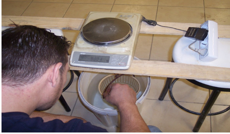
Foto 13- Numunenin Sudaki Ağırlığının Bulunması
