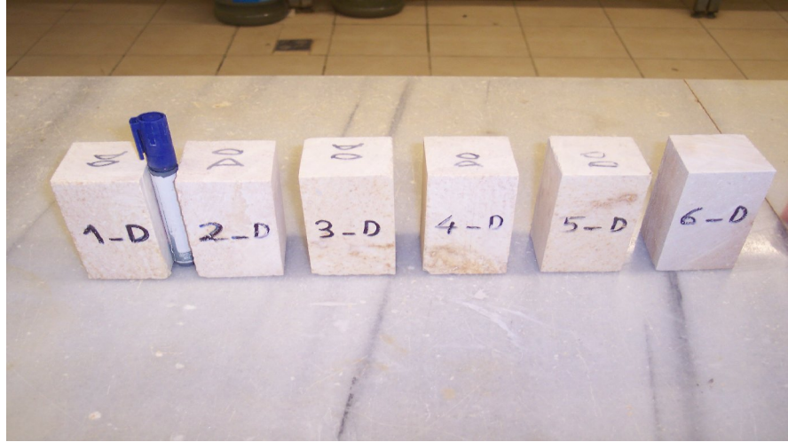
Foto 9- Çanakkale Çan'ın Sarımsı Bej Renkli Litik Tüfünün Numuneleri (D)
