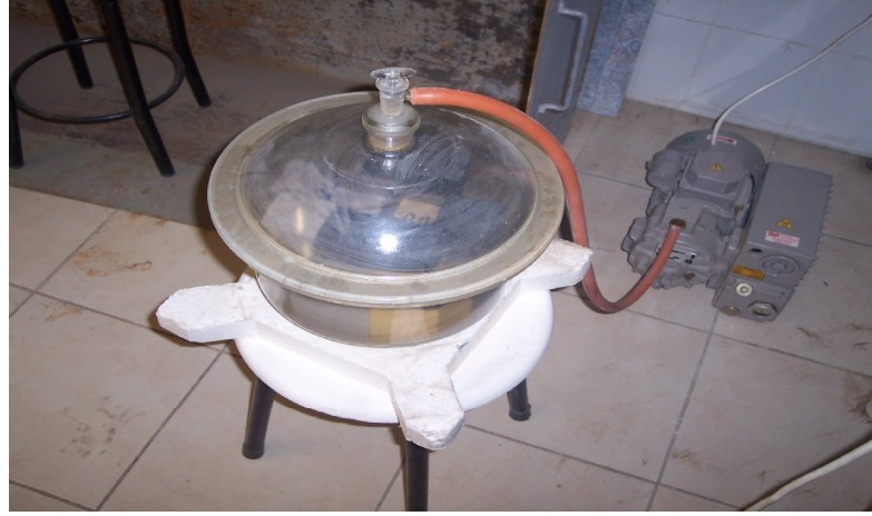
Foto 11- Numunelerin Vakum Desikatöründe Havaının Alınması
