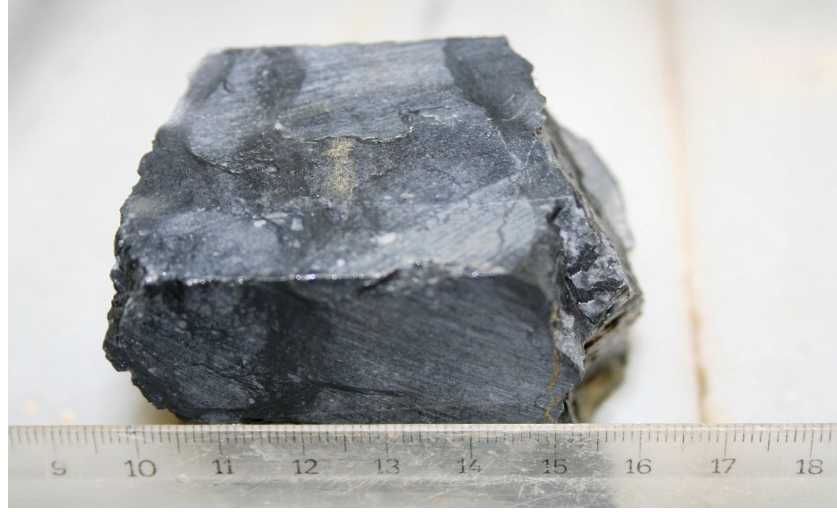
Foto 2- İstanbul Kartal'dan Gri Renkli Kalsit Damarlı Mikritik Kireçtaşının (B) Görünümü.
