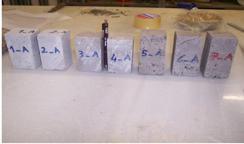
Foto 6- řırnak Blgesinin Kahverenkli-Gri Renkli Kristalize Kiretařının (Litosparit) Numuneleri (A)
