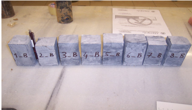
Foto 7- İstanbul Kartal'ın Gri Renkli Kalsit Damarlı Mikritik Kiretařı Numuneleri (B)
