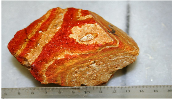
Foto 4- Çanakkale Çan'dan Sarımsı Bej Renkli Litik Tüfün (D) Görünümü.
