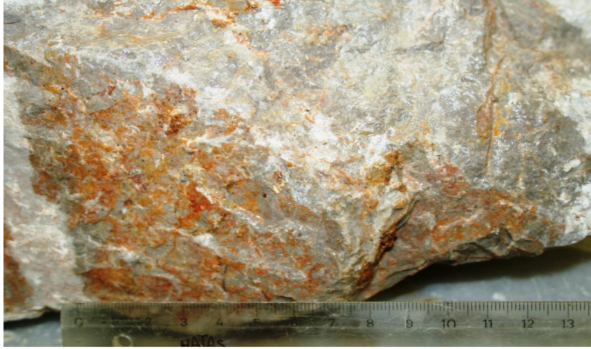
Foto 3- İstanbul Gebze'den Açık Gri Renkli Dolomitik Kireçtaşı'nın (C) Görünümü
