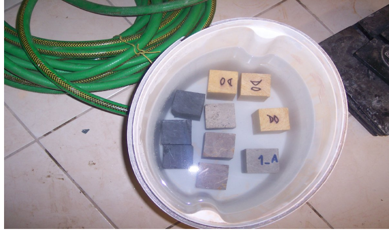
Foto 12- Numunelerin Hava Alındıktan Sonra Su İçerisinde Bekletilmesi
