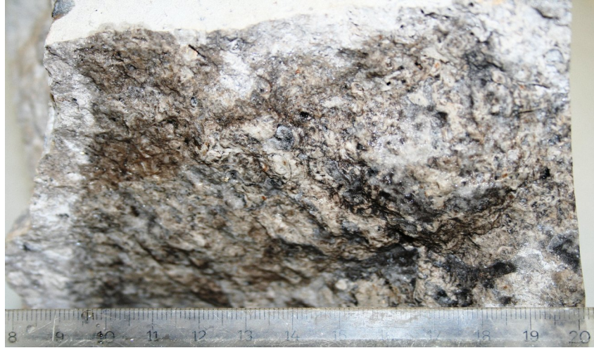
Foto 1- Şırnak Bölgesinden Kahverenkli-Gri Renkli Kristalize Kireçtaşının (Litosparit) (A) Görünümü.
