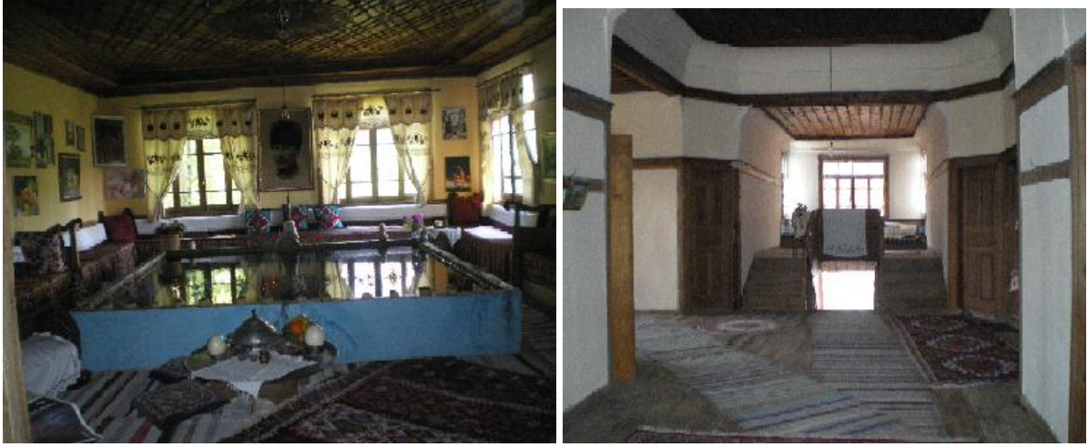
Resim-5.2.17 Asmazlar Konağı Havuzlu Baş Oda ve Üst Kat Sofa Görünümü. Orta katta bulunan havuzlu baş odanın sedirleri ahşap olup, sedir yüksekliği pencere parapet seviyesine göre ayarlanmıştır. Tavan ahşap olup, ortada bir göbek ve ince çıtalarla elde edilmiş geometrik desenler dikkat çekmektedir. Üst kat sofasının tavanı ise; tekne tavan şeklinde yapıldığı görülmektedir. Burada sofa daha yüksek ve süslü yapılmıştır. Böylece sofa daha merkezi ve egemen olarak görülmektedir. (S.Gülçin Bozkurt,2009)
