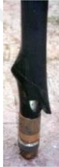
Şekil 3.34. Presiyometrenin genişlemesine zemin tabakalarının etkisi.
