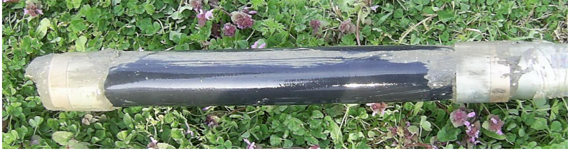
Şekil 3.37. 74 mm'lik (gc3) 3mm kauçuk membran ile kaplı prob; İSKİ Çatalca Tüneli, yumuşak kilde yapılan deney sonrası probun görünüşü.
