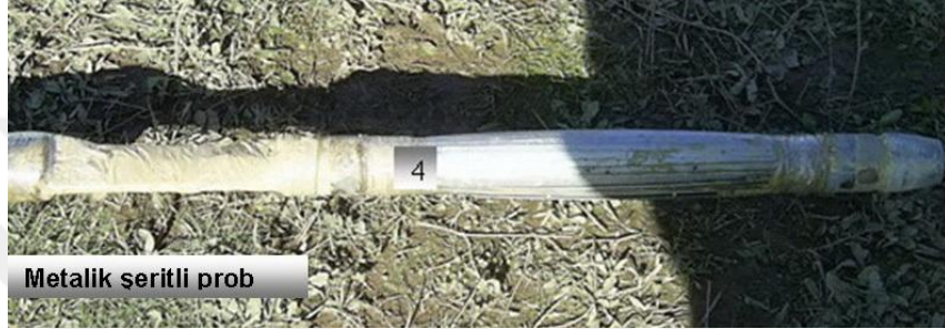
Şekil 3.10-a. Farklı türlerde prob kaplamaları (kılıf) (1, 2, 3, 4)
