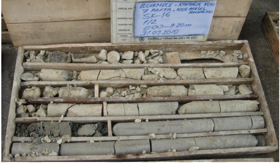
SK-16 sondajına 0.0-9.20 m ler arasındaki konsolide kil aratabakalı çamurtaşları
