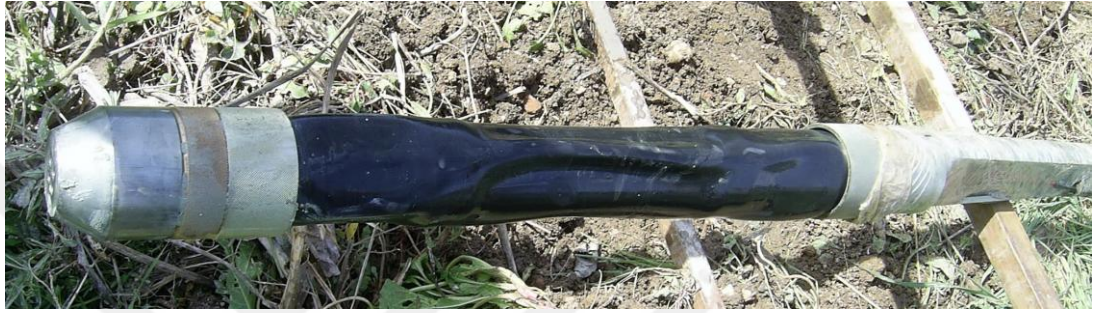
Şekil 3.38. 74 mm'lik (gc3) 3mm kauçuk kaplı prob; Bakırköy Fm. Kireçtaşı - kil ardışımı, deney sonrası hem yüksek basınç hem de farklı tabakaların proba etkisi (Ataköy SK-3 Sondajı).
