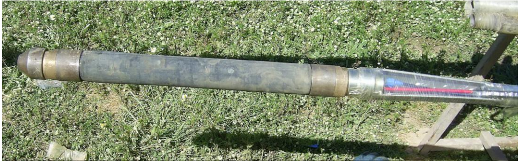
Şekil 3.39. 60 mm'lik (gct-75) çelik şeritli kanvas kılıf ile kaplı prob; deney öncesi (Sancaktepe SK-2 Sondajı)
