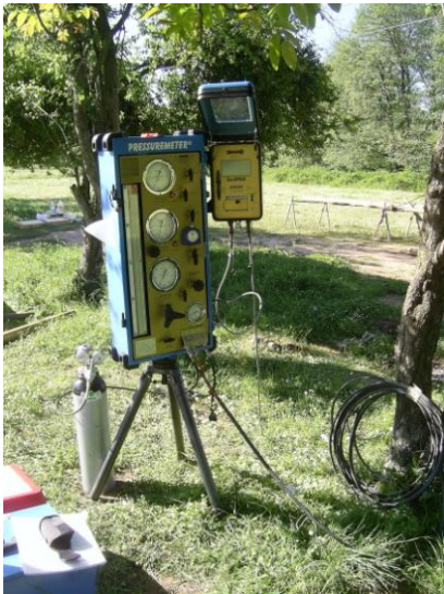
Şekil 6.4. Kurtköy Sancaktepe ve farklı bir proje sahasın presiyometre deneyi ölçümleri.
