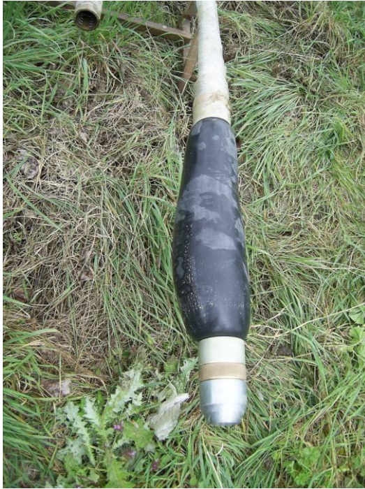
Şekil 3.35. Proben patlaması sonucunda oluşan genişleme.
