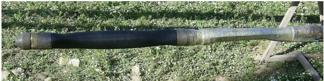
Şekil 3.40. 60 mm'lik (gct-75) çelik şeritli kanvas kılıf ile kaplı prob; Deney sonrası (Sancaktepe SK-2 Sondajı) çok ayrılmış granit (arena) dayk geçişli farklı istifleri içinde düşük basınçta bile düzensiz basınç dağılımı.
