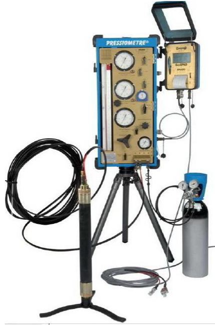
Şekil 2.14. Menard tipi presiyometre takımı.
