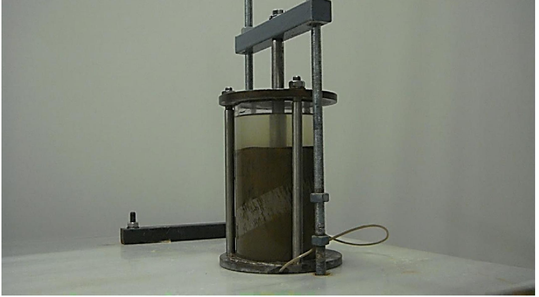
Şekil 4.4: Hazırlanmış bulamaca ön konsolidasyon basıncının uygulanması
