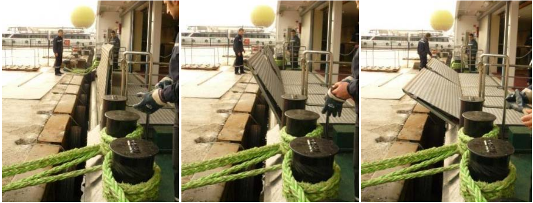
Şekil 3.1 : Şehir Hatları vapurlarında kullanılan hidrolik iniş/biniş rampası (URL-12)
