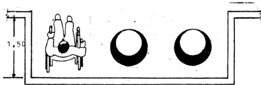
Şekil 3.28 : Oturma yeri ve tekerlekli sandalye kullanıcısı için sandalye nişi (TS 12460, 1998: 21)
