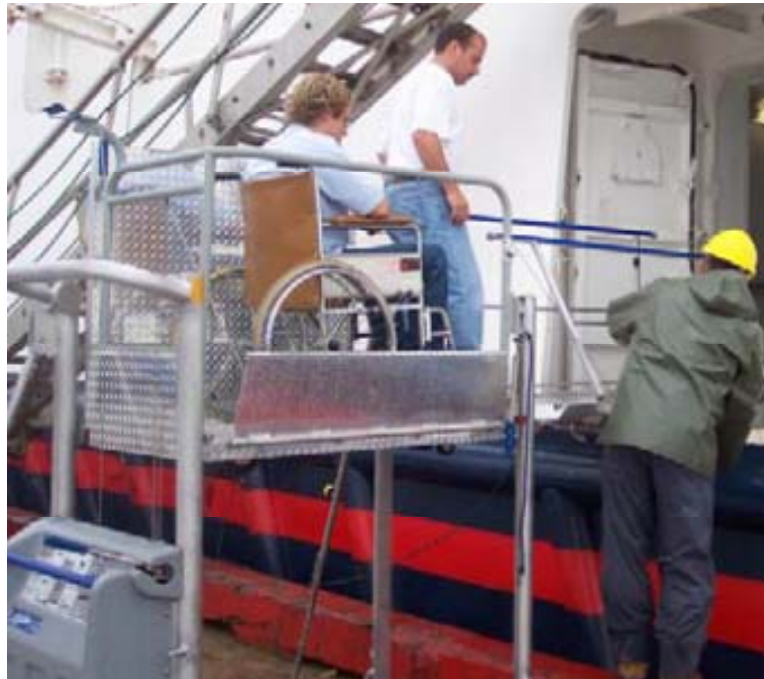
Şekil 3.38 : Tekneye iniş/binişi sağlayan portatif hidrolik sistem örneği (URL- 16)
