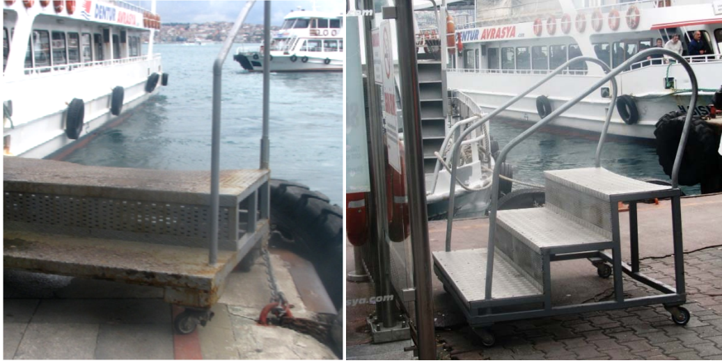
Şekil 3.37 : Tekneye iniş/binişi sağlayan portatif merdivenler (Özgel, S., 2011)
