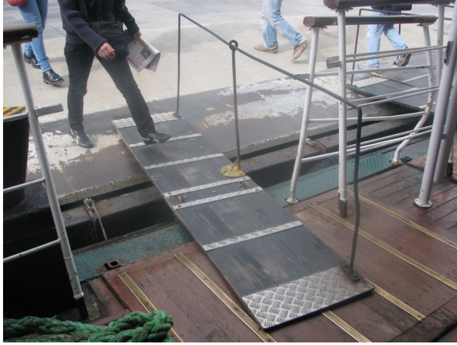
Şekil 3.34 : Sürme iskele (Özgel, S., 2011)
