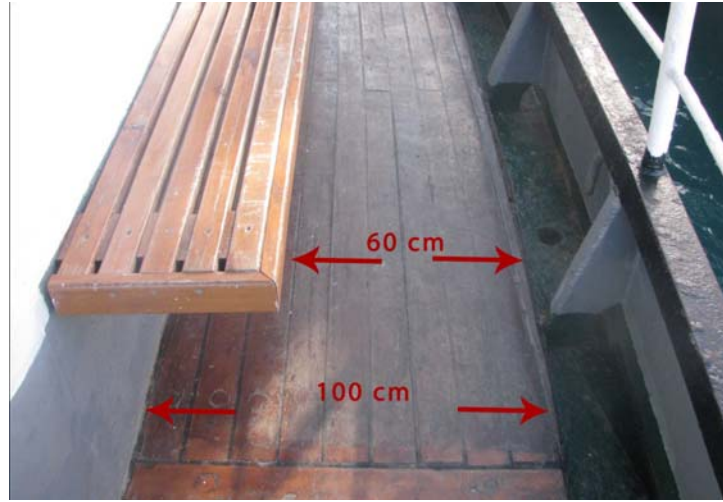
Şekil 3.52 : Yan güverte geçiş genişliği (Özgel, S., 2011)
