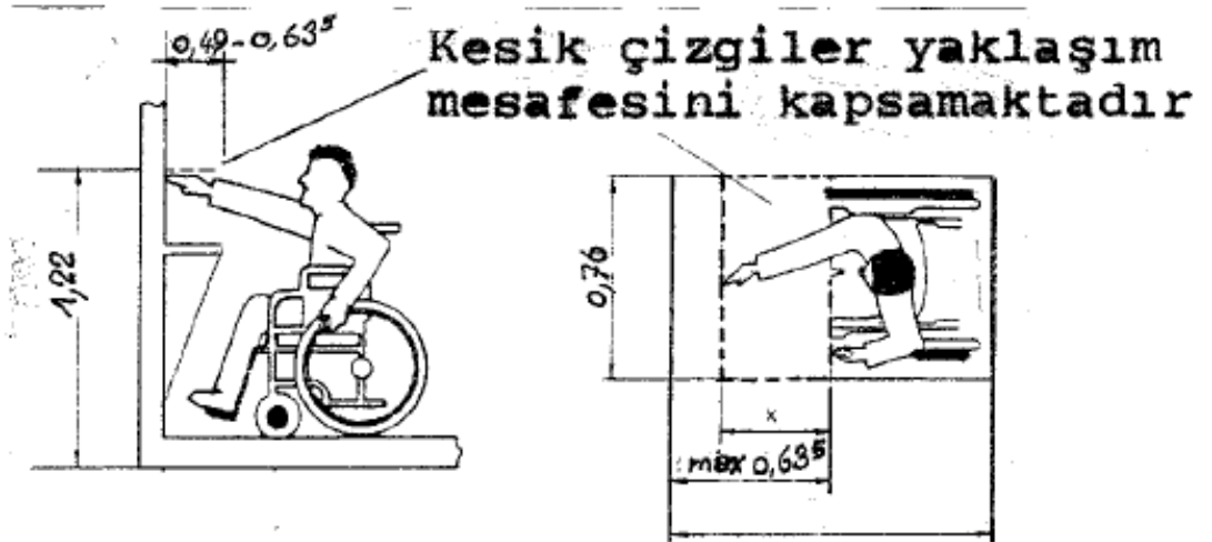
Şekil 3.18 : Engelsiz önden yaklaşım mesafeleri (TS 12460, 1998: 17).
