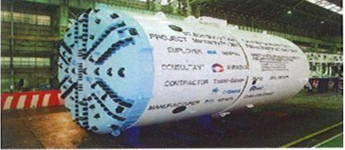
Şekil 4.21 Tünel Açma Makinasının 11 Metrelik Ön Kısmı
