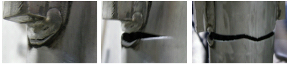
Şekil 4.39 RW numunelerinde uç dönüş kaynağı tipik hasar gelişimi.
