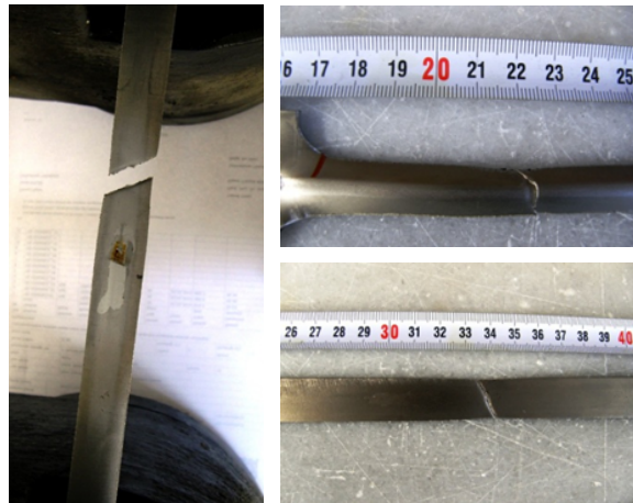
Şekil 4.5 Çekme testi sonrası kopmuş kupon görüntüleri.
