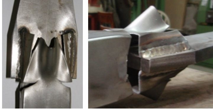
Şekil 4.40 Kutu profil numunelerinde tipik ileri hasarlar.
