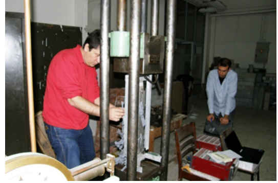
Şekil 4.19 Üniversal hidrolik test makinası ve düzeneğin kurulması.
