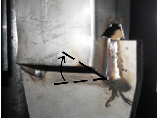
Şekil 4.31 S-L30-NW numunesi profil ağzı eğikliği ve kesitte çarpılma.
