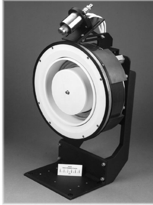
Şekil 3.1 NASA-173Mv2 Hall itme motorunun bir fotoğrafı [1]
