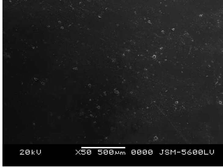
Şekil 4-39 Toyota Corolla marka 2009 model Metalik (Gümüş) Gri renkli boya gamının elektron mikroskobu görünümü
