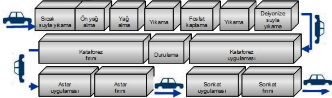
Şekil 2-16 Binek araç boyahanesinde araca uygulanan işlemler (kansaiaktan 2008).
