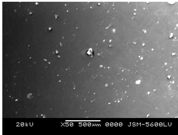
Şekil 2-11 2012 model Toyota Corolla marka Siyah renkli boya gamının Elektron Mikroskobu görüntüsü
