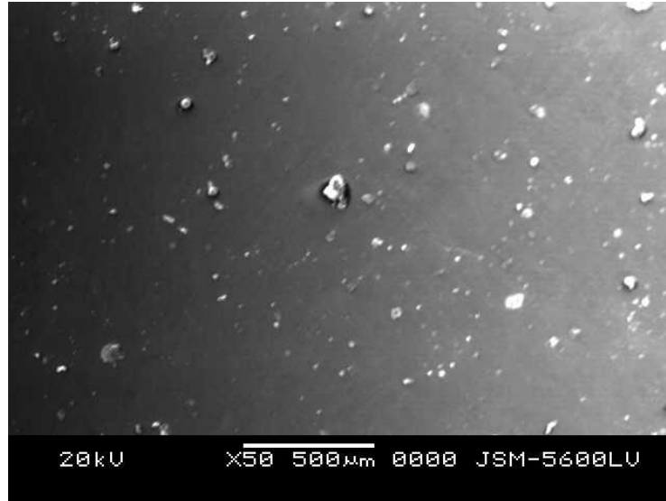
Şekil 4-68 2012 Model Toyota Corolla marka Siyah renkli boya gamının elektron mikroskobu görünümü
