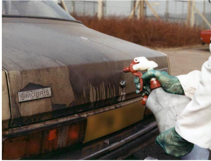
Şekil 2.28 SPR yönteminin araç yüzeyine uygulanması (S.M.Bleay 2012)
