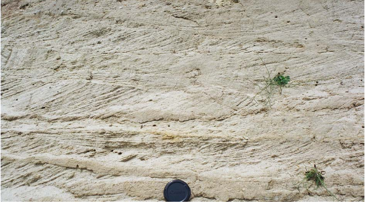
Şekil 2.9: Küçükçekmece Gölü yakınındaki bir kum ocağından alınan, Çukurçeşme formasyonuna ait çapraz katmanlı kum düzeylerinden bir görüntü (İ.B.B. Deprem ve Zemin İnceleme Müd., 2011)
