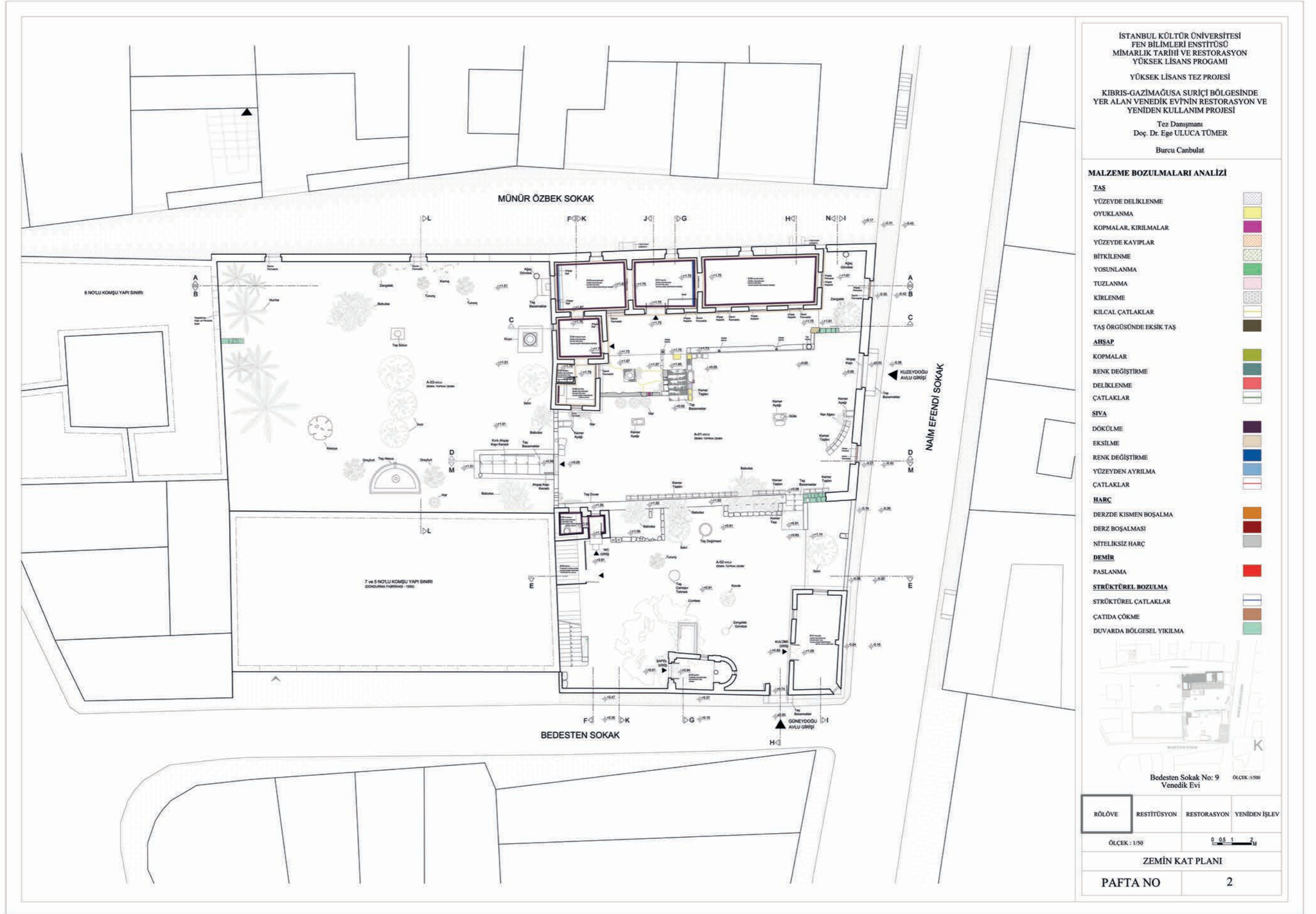
Şekil 3.123 : Zemin Kat Planı - Malzeme Bozulmaları Analizi (2015)
