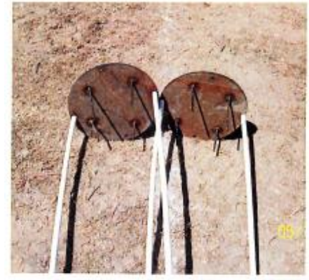
Şekil 2.50 Taş Kolon Yükleme Düzenegi (Kurt, 2011)
