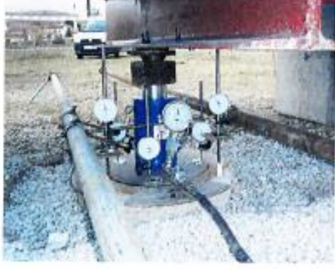
Şekil 2.50 Taş Kolon Yükleme Düzenegi (Kurt, 2011)
