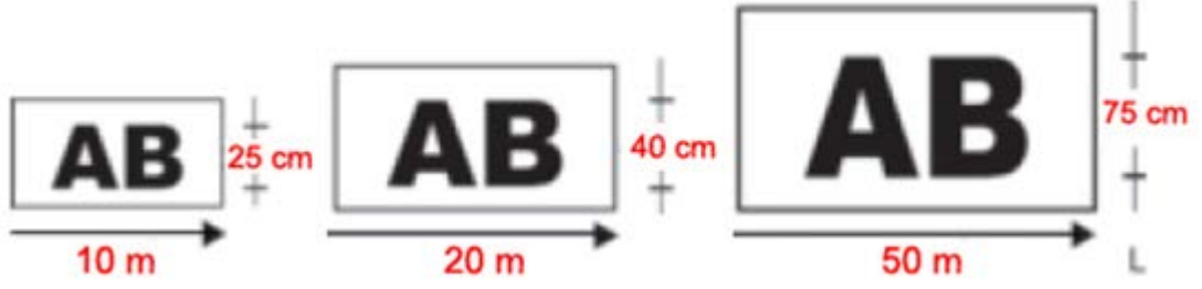
Şekil 60: Bilgilendirme işaretlerinde okuma uzaklığı ve yazı büyüklüğü
