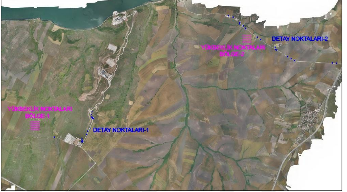
Şekil 5.15: Konum ve yükseklik doğruluklarını karşılaştırma noktaları (BirinciUygulama Alanı) (Tez çalışması kapsamında yazar tarafından hazırlanmıştır.)
