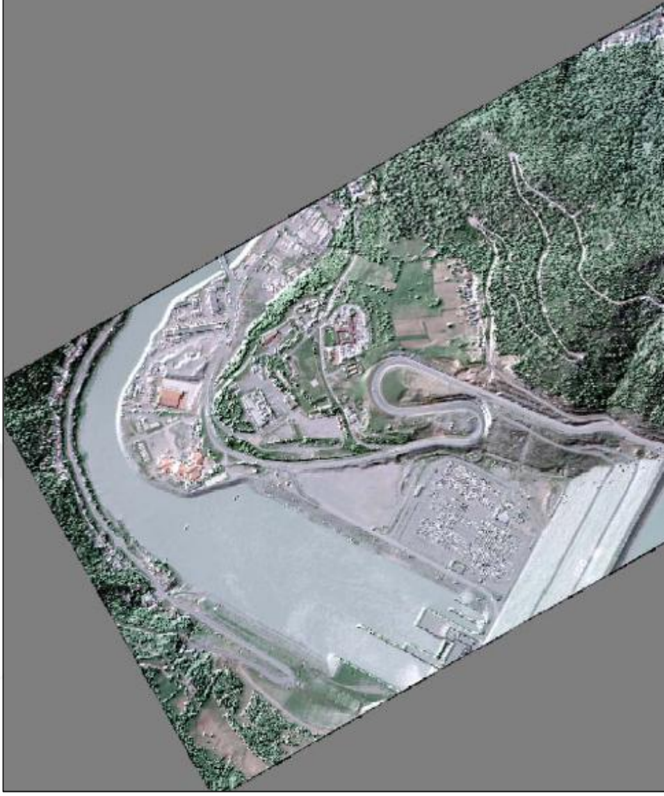
Şekil 3.10: LIDAR-Sayısal Yüzey Modeli (DSM) verileri üzerine geçirilmiş ortofoto görüntüsü (Bölme, Murat., (2013). LIDAR İle Sayısal Arazi Modeli Üretimi ve Sistemin Doğruluğunun ve Kullanılabilirliğinin Araştırılması , Yüksek Lisans Tezi, Aksaray Üniversitesi Fen Bilimleri Enstitüsü, Aksaray.)
