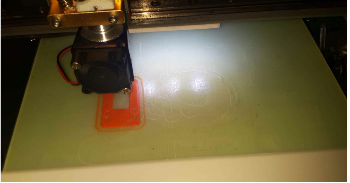
Şekil 2.9. Motor Tutucunun 3D Printerda Baskısı
