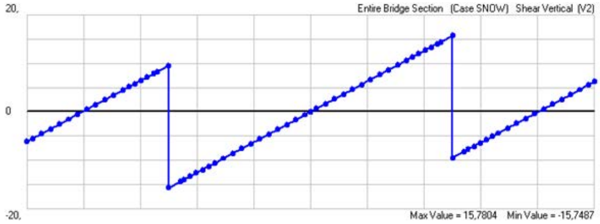
Şekil 3.46. Kar Yüğü İçin Elde Edilen Kesme Kuvveti Diyagramı
