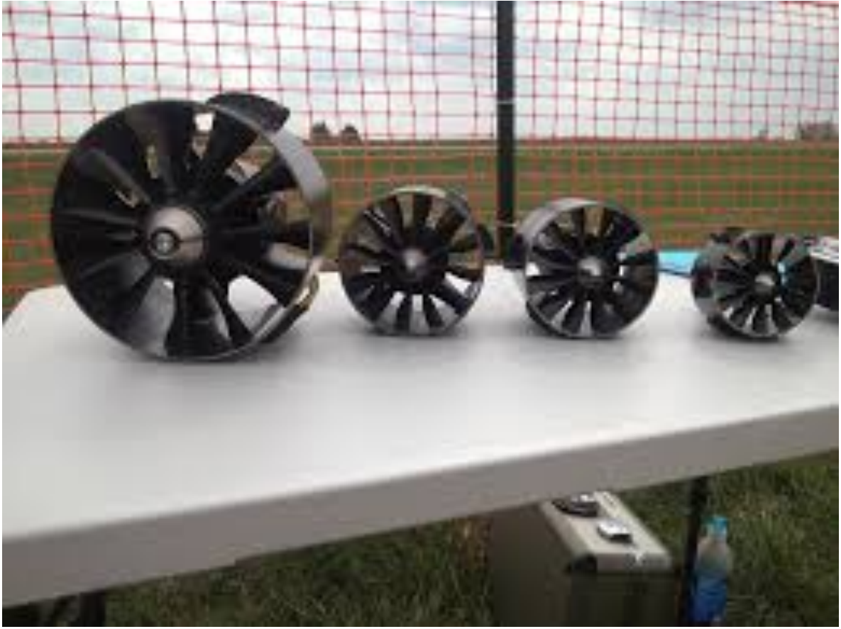
Resim 3.1: Çeşitli çaplardaki EDF motorlar
