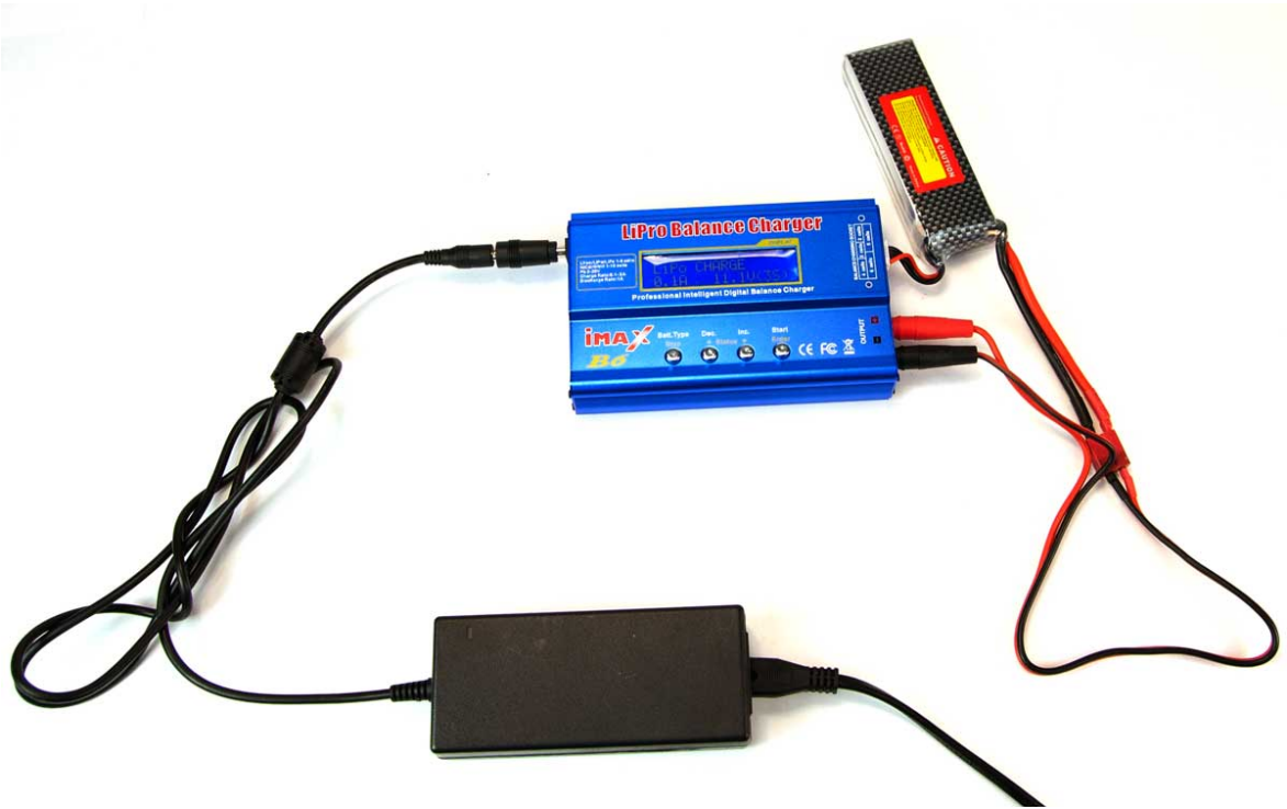
Resim 3.16: Li-Po bataryayı şarj etme esnasına ait resim
