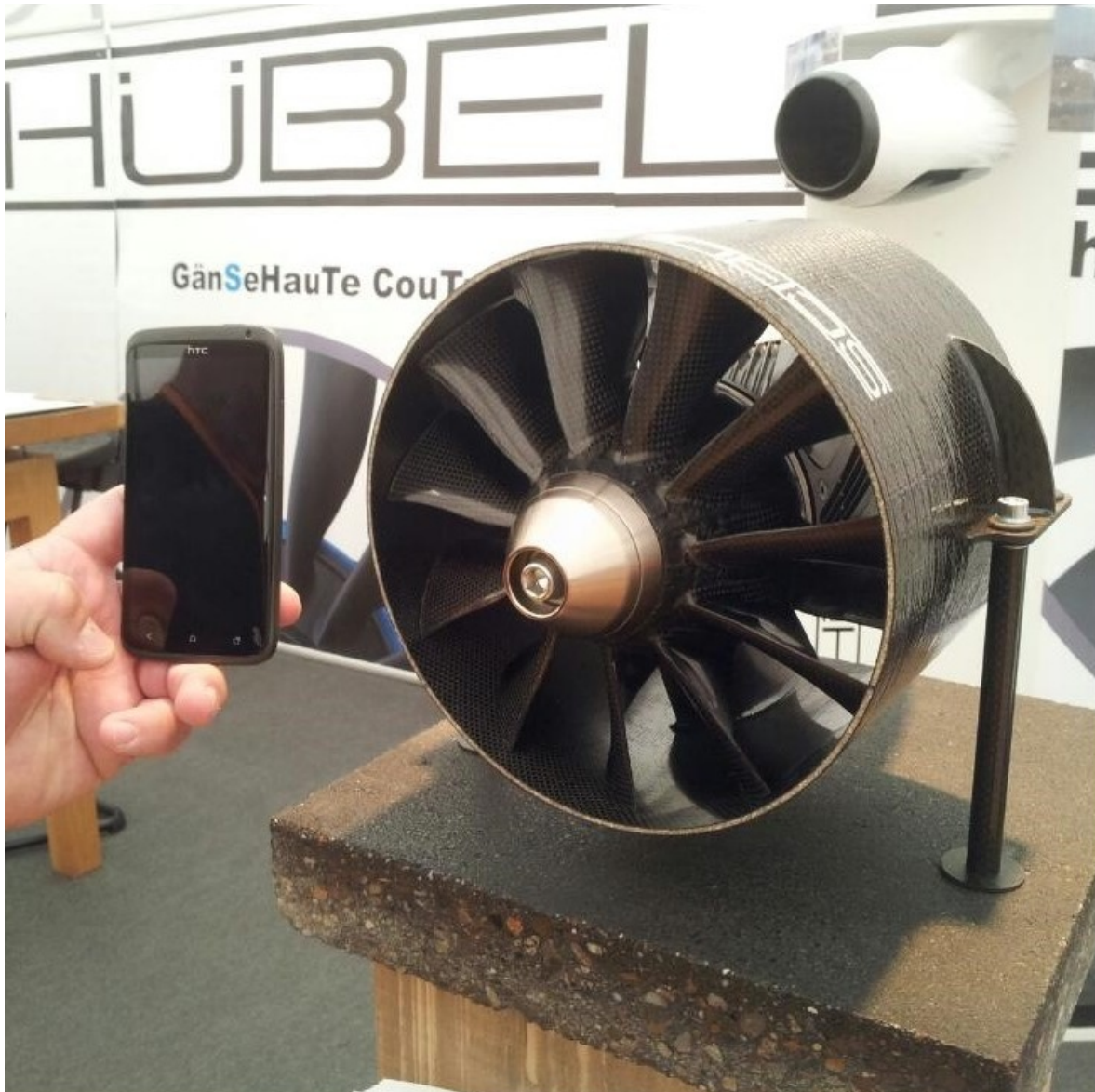
Resim 3.2: 140mm apındaki karbon pal ve gvdeye sahip EDF motor
