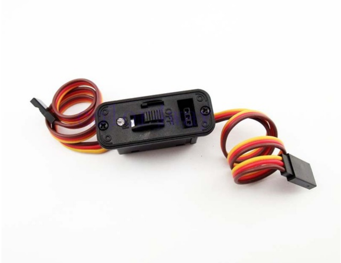
Resim 5.43: 2 konumlu elektronik anahtarı
