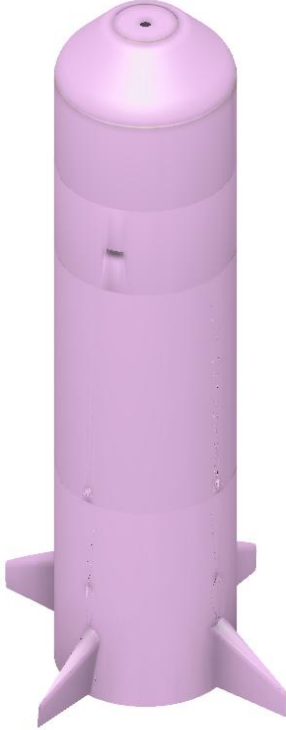
Şekil 4.31: Seyir füznesinin montaj çizim aşaması.
