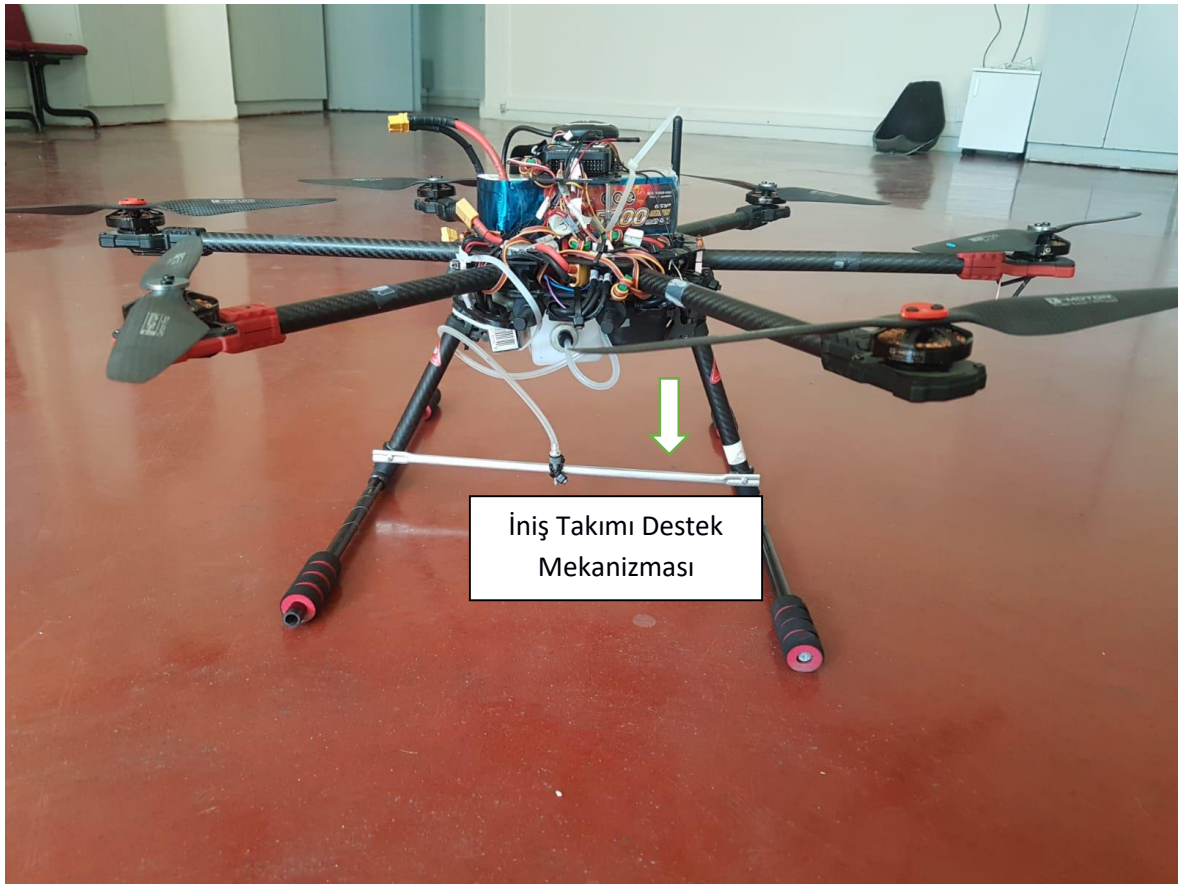
Şekil 6.7. Hexatar İçin Oluşturulan İniş Destek Mekanizması
