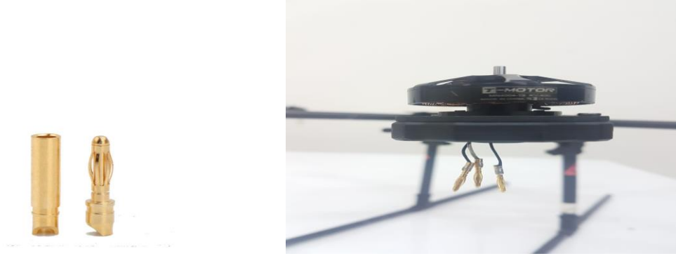
Şekil 2.17. Hexatar İçerisinde Yer Alan Motor Konnektörü ve Bu Konnektör ile Bağlantısı Gerçekleştirilen MN-4004 Motoru
