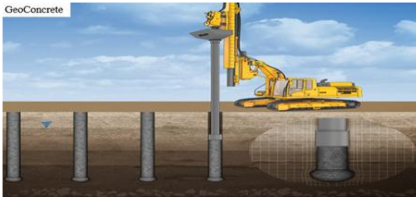
Şekil 2.51 GeoConcrete kolonların imalat tekniği[42]
