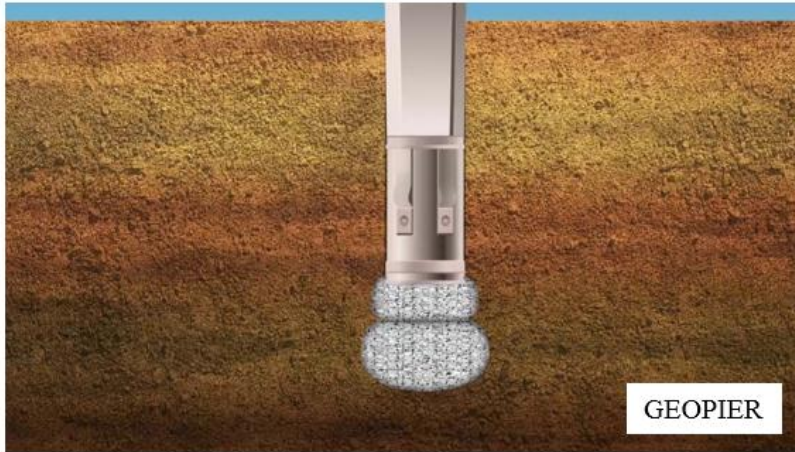
Şekil 2.49 Geopier yöntemi ile kolon oluşturma[42]
