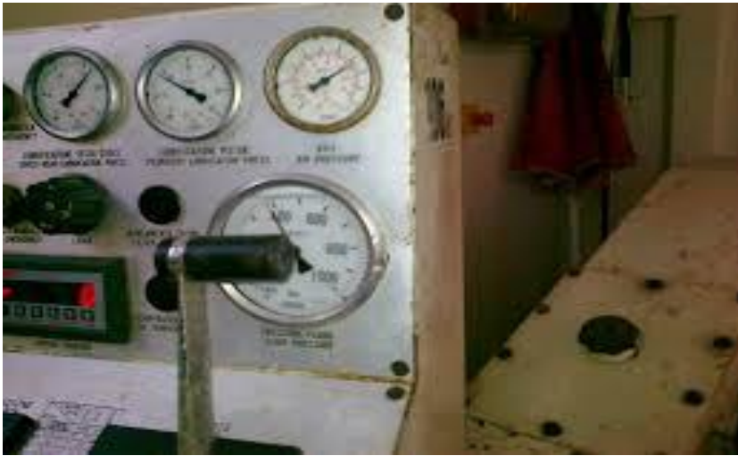
Şekil 2.23 Jet grout kolon teşkili için kullanılan enjeksiyon ve pompa ünitesi[21]
