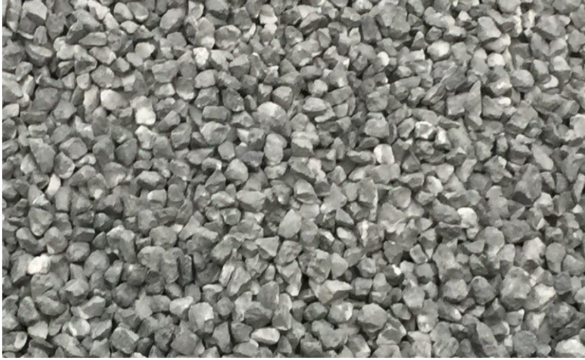
Şekil 2.44 Taş kolon imalatında kullanılan granüler malzemesi[38]
