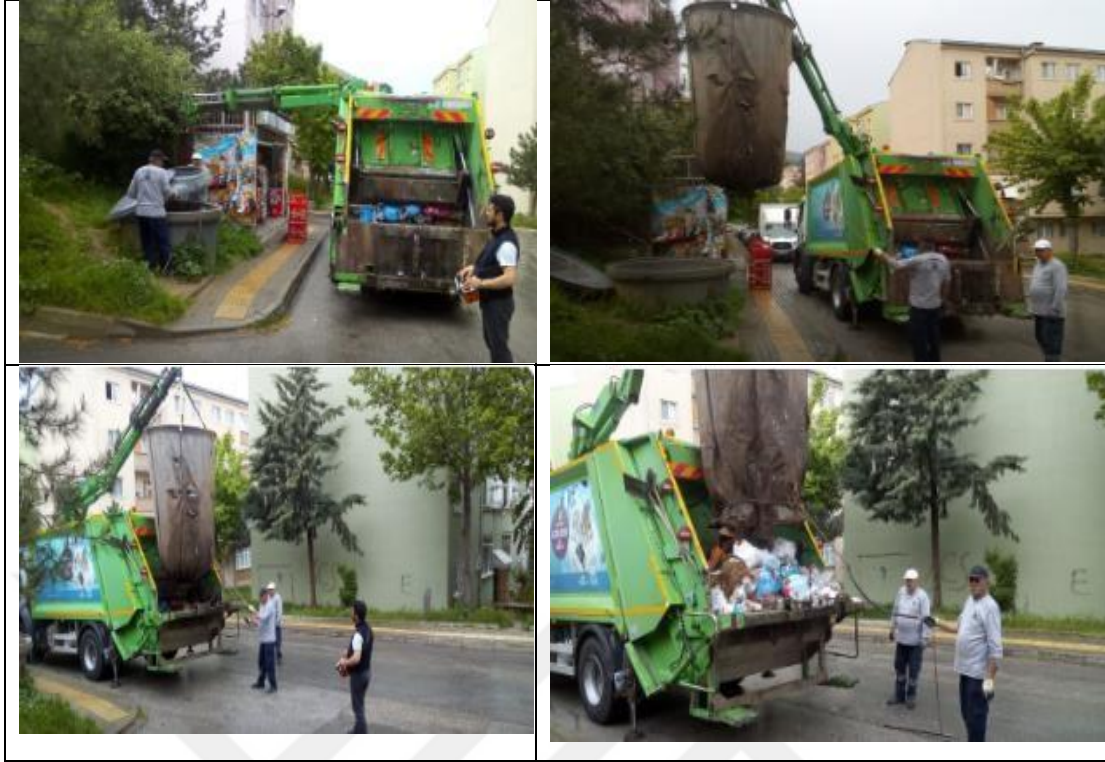
Şekil 5. Çöp Konteynırının Taşınması, Araca Boşaltılması Ve Yerine Konulması Tablo 23. Düzeltici/ Önleyici Faaliyetler Sonrasında Rahatsızlıkların Ve İş
