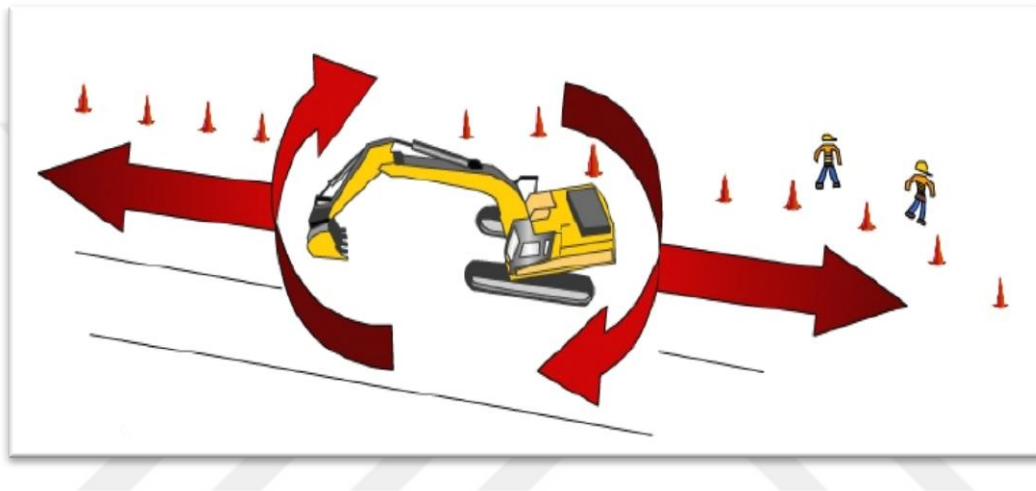
Resim 3.1. Yapı makinaları için tehlikeli bölge sınırlaması örneği 8
