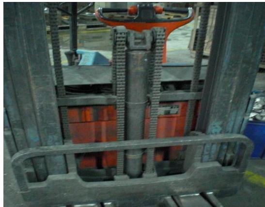
Şekil 5. 27. Dişlileri Muhafaza Edilmemiş Forklift Zincirleri
