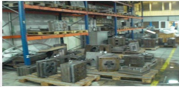
Şekil 5. 18. Kalıpların Tahta Paletlerle Taşınma ve Depolanması
