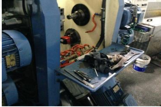
Şekil 5. 14. Durudurulmadan Bakımı Yapılan Çok Başlıklı CNC Tezgahı
