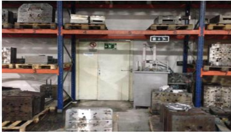
Şekil 5.3. Acil Çıkış Kapısının Yanlış Yönlendirilmesi
