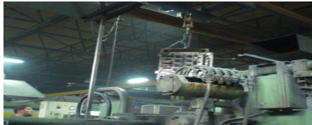
Şekil 5. 13. Enjeksiyon Makinası Kalıp Takım İşlemi
