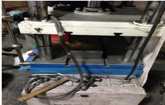
Şekil 5.16. Makine Çevresinde Yerine Bırakılmayan Bakım ve Onarım Malzemeleri
