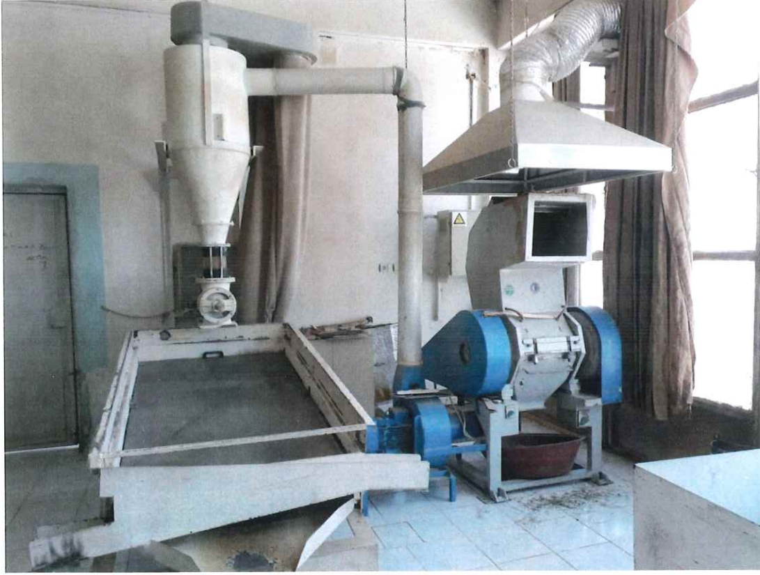
Şekil 25. Bitkilerin Otomatik Olarak Eleğe Aktarılması Sistemi
