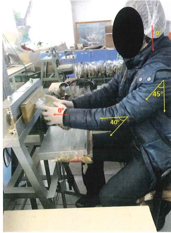
Şekil 38. Ambalajı Yapıştırıcı İle Kapama İşi
