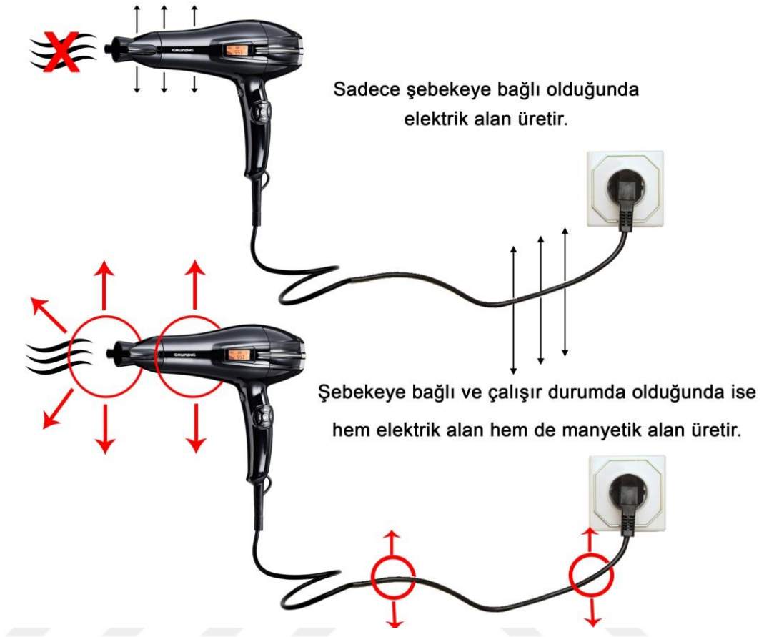
Şekil 3. Elektrik alan ve Manyetik alan karşılaştırması.
