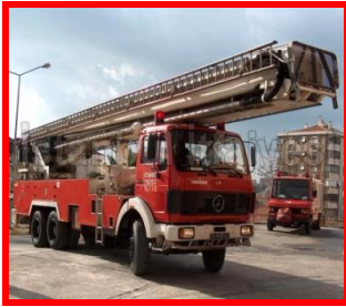
Şekil: 2.13 Platformlu mafsallı merdiven aracı (30 metre)
